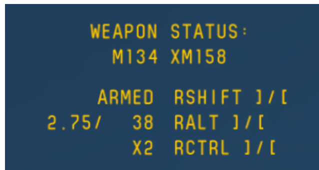
Figure 2.3. Индикация статуса вооружения: ARMED (главный выключатель включен), 2.75 (XM158 активное вооружение), 38 (текущий остаток НАР), X2 (выбран режим по две ракеты из каждого блока).
