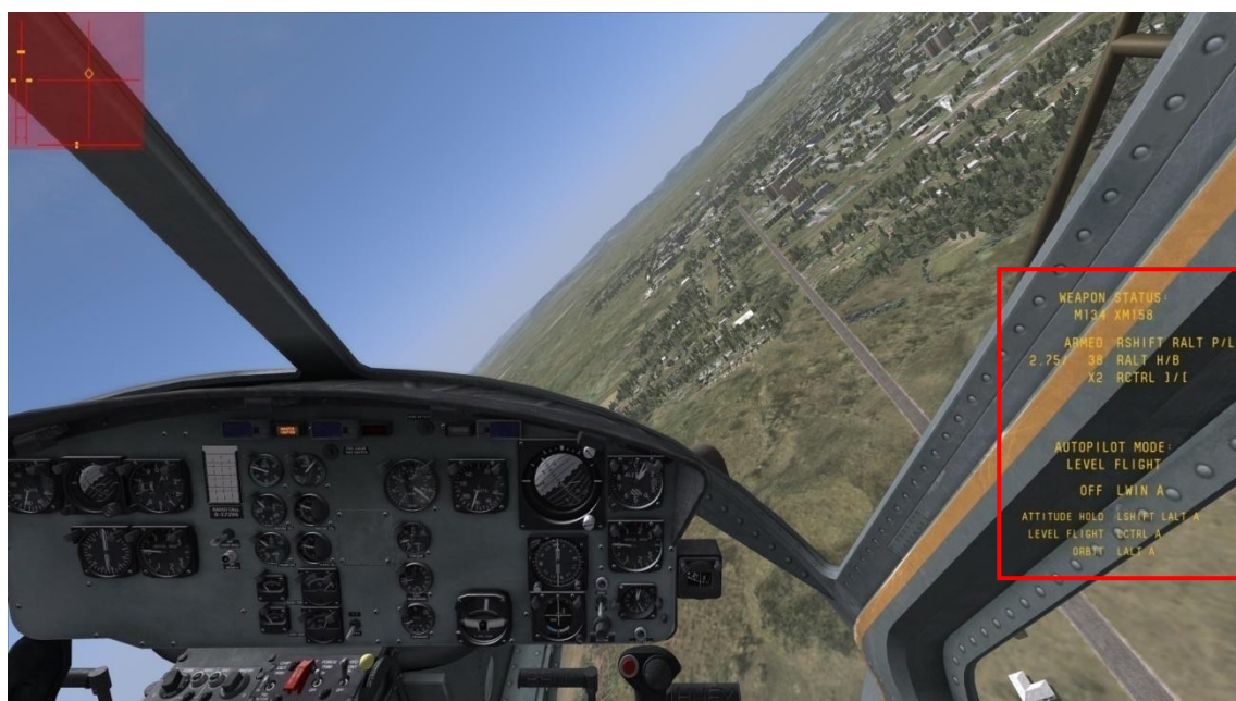
Figure 2.1. Положение индикатора статуса вооружения и режима АП.
