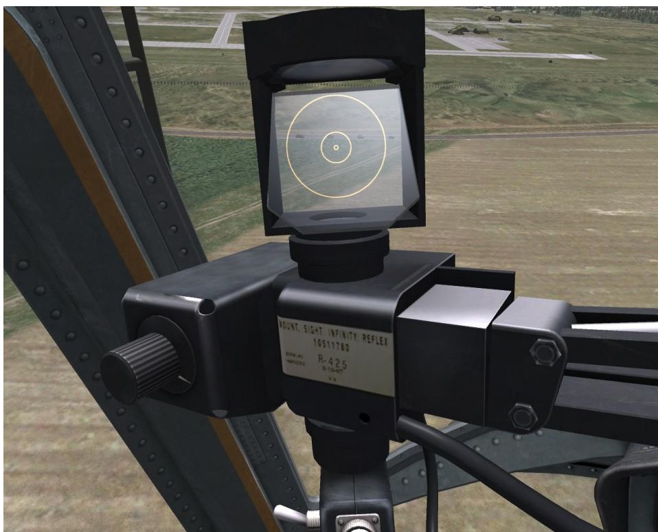
Figure 2.5. Прицел левого пилота в подвижном режиме повернут влево (FLEXIBLE MODE) (1 of 2)
