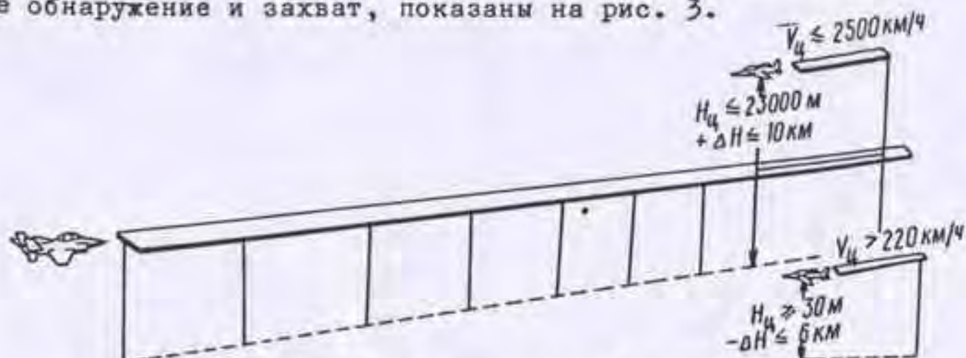
РИС. 3. ДИАПАЗОНЫ ВЫСОТ И СКОРОСТЕЙ ПОЛЕТА ЦЕЛИ ДЛЯ ОБНАРУЖЕНИЯ И ЗАХВАТА РЛК НА ВСТРЕЧНО-ПЕРЕСЕКАЮЩИХСЯ КУРСАХ
