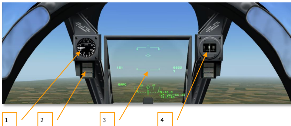
4-42: Приборы на переплете фонаря кабина самолета А-10
