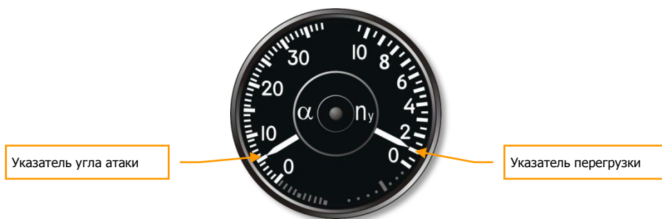
3-40: Указатель угла атаки и перегрузки
