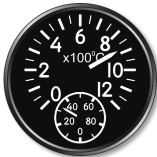
3-47: Индикатор температуры газов за турбиной
