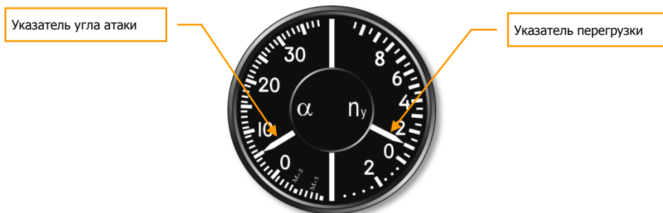
3-6: Указатель углов атаки и перегрузки
