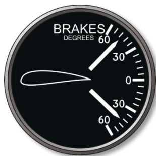
4-59: Указатель положения воздушных тормозов
