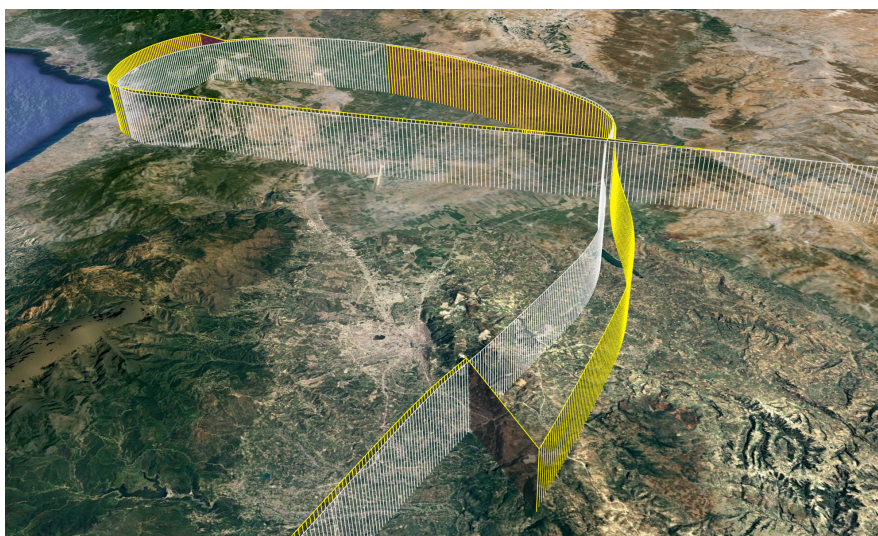
Рис 5. Коррекции ИНС. Белый граф - истинное положение ЛА на маршруте, желтый - расчётный, на основе работающей ИНС.
