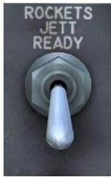
该开关允许所有火箭弹在紧急情况下通过炸弹—火箭弹释放按钮丢弃。
