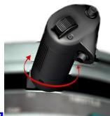
逆时针转动扭转手柄直到它停止 [; ] (增加距离) —对于更改 A-4 瞄准具距离输入模式：从手动到雷达测距单元。
