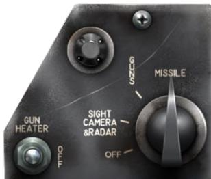
射击安全开关（机枪-导弹选择开关）位于 SIGHT & CAMERA RADAR。按下扳机到第一级止动以操作照相枪，只要按下扳机，该摄像机将继续运行，在从 0 到第 5 秒时超限。在机枪，火箭弹或导弹发射时，照相枪也能工作。
