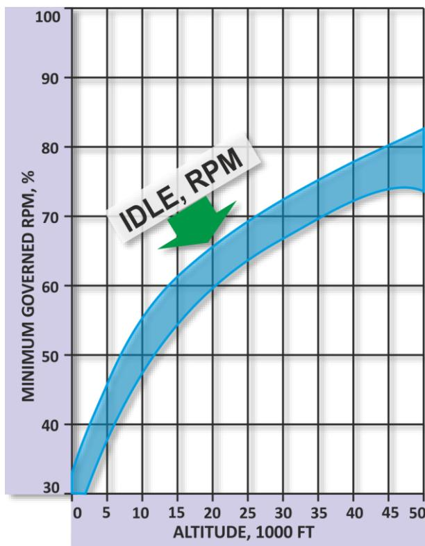
图 3.15. 慢车转速 (RPM) 与飞行高度
