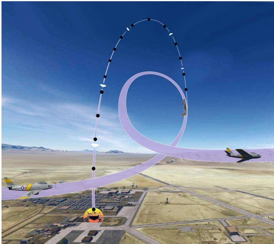
图 11. 1 LABS 操作的一般原理
