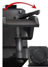
将瞄准具机械锁定杆移至 UNCAGE。
