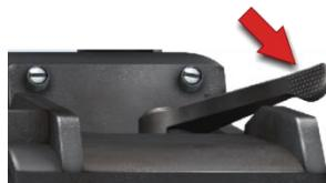
(3) 机械锁定杆。瞄准具机械锁定杆允许机械地锁定瞄准具陀螺仪以防止飞机处于地面上时（移动或不移动）以及陀螺仪故障时的损坏。
