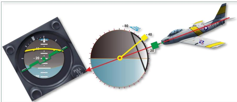
图 4.8 仪表及其元素在  $20^{\circ}$  俯冲和  $30^{\circ}$  左转弯中的相对位置
