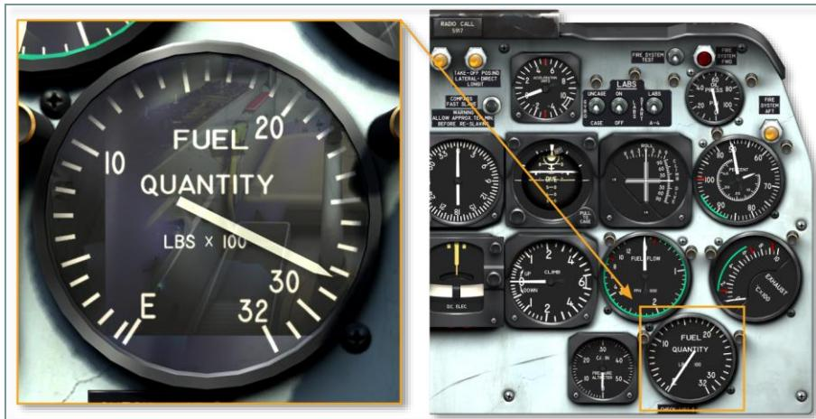
安装在仪表板上的燃油油量表可以监控剩余燃油量。它表示由密度计型指示系统确定的总内部燃油供应量（磅），该系统由主要总线供电。它可自动补偿燃油密度变化，因此无论使用何种燃油，无论燃油膨胀或温度变化引起的收缩，油量表都会记录燃油的实际磅数。（非补偿系统虽然以磅为标准单位，但基于体积，因此无法准确显示燃油重量）。
