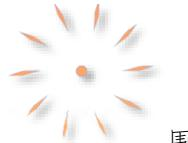
瞄准具标线图像由一个中心点和十个等间距菱形点（或菱形）围成的圆组成。这些菱形图像被投射到瞄准具的反射玻璃上，并且可以根据所操作的武器和瞄准操作模式在这个玻璃上移动，如图 6.17 所示。
