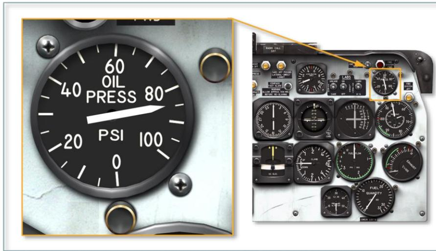
标有“OIL PRESS”的B-20滑油压力计位于仪表板的右上角，以磅/平方英寸(PSI)记录发动机滑油压力。
