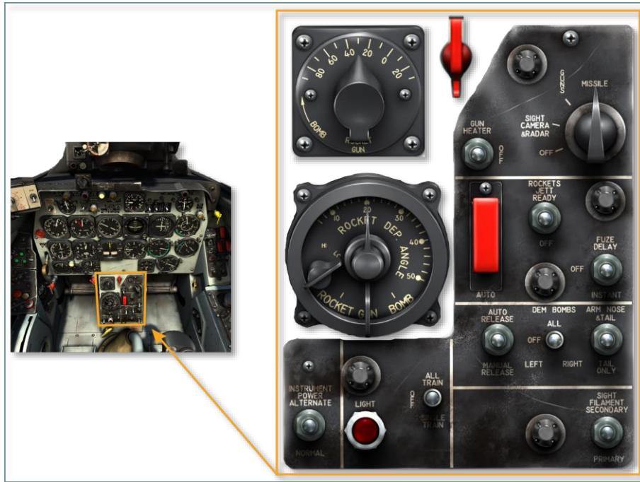
紧急控制面板。紧急控制面板（图 4.1,9a）位于中央基座上，位于武器面板下方，包含座舱盖分离手柄（黄色，[详情参阅此处](#)）和起落架紧急释放手柄**紧急释放手柄**（红色）。
