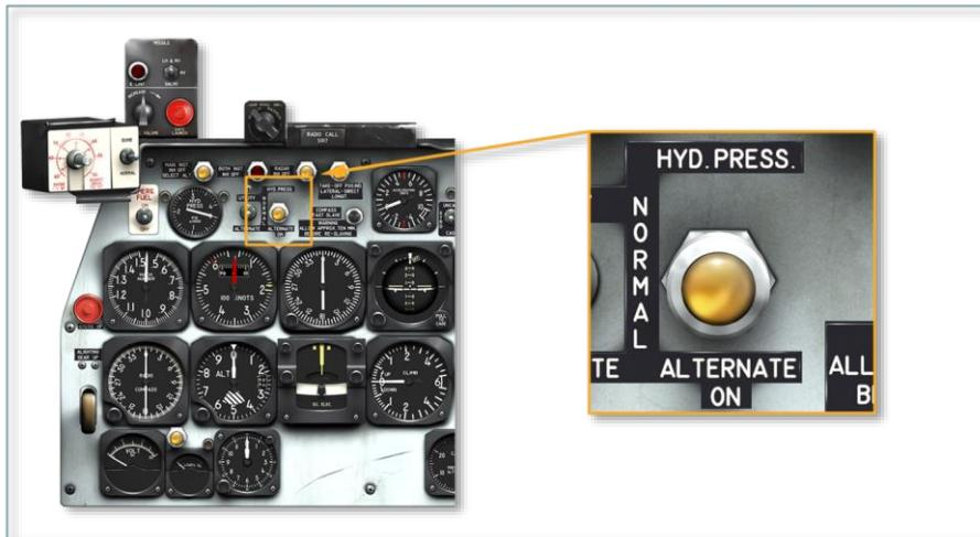
在液压系统操作设备切换到备用液压系统时，安装在仪表板上的琥珀色备用告警灯亮起。只要飞行控制备用液压系统运行，它就会一直亮起。通常由主要总线提供用于点亮灯具的电力。但是，如果没有可用的主要总线电力，则由电池总线的电力点亮指示灯。
