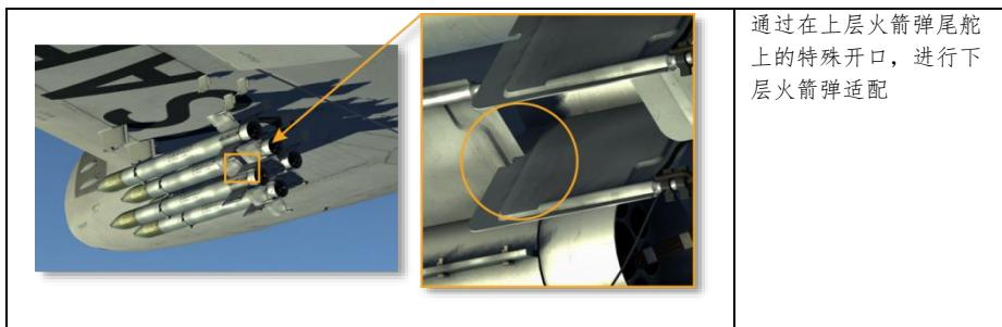
由于下层火箭通过上层火箭结构部件安装，因此在火箭弹发动机发生故障的情况下不能发射上层火箭（未提供火箭弹故障模拟）。
