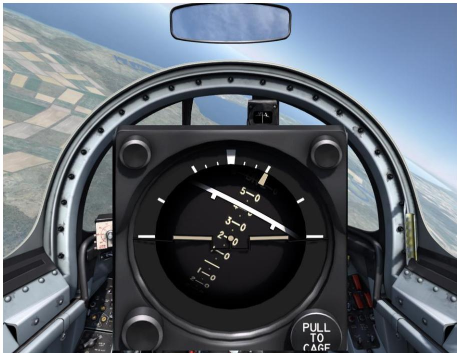
图 4.9 地平仪在  $20^\circ$ 俯冲和左转  $30^\circ$ 时读数
