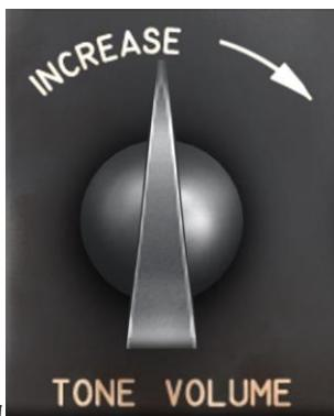
4. 转动音量控制旋钮，使背景信号处于低音量。
