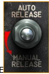
4. 将爆破炸弹释放选择开关置于 MANUAL RELEASE。
