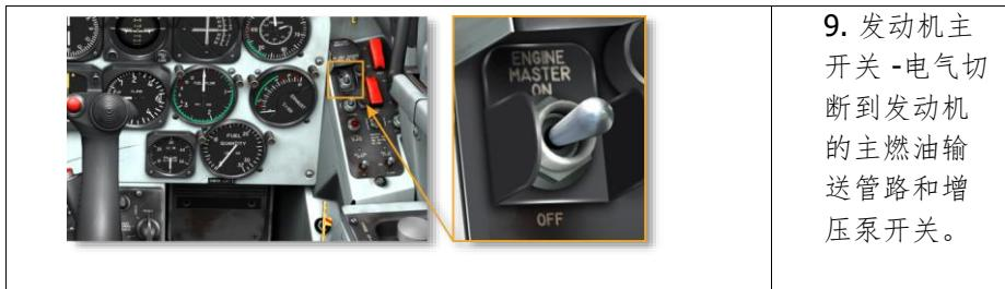
9. 发动机主开关 - 电气切断到发动机的主燃油输送管路和增压泵开关。
