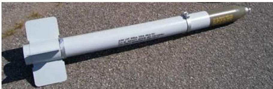
图 1.18. 无制导 127 毫米 HVAR（高速航空火箭）
