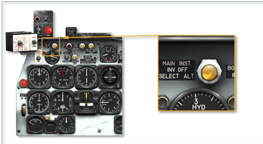
琥珀色，推入式测试型主逆变器警示灯安装在仪表板上。当主仪表（三相）逆变器发生故障时，它会由主要总线的电力点亮。当指示灯亮起时，应通过将仪表电源开关移至 **ALTERNATE (ALT)** 来选择备用三相逆变器。只要仪表电源开关处于 **ALTERNATE (ALT)** 位置，指示灯就会一直亮着。
