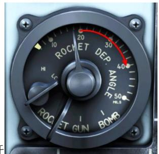
7. 在瞄准具选择单元上: 操作火箭弹设置杆, 设置火箭下坠校正:
