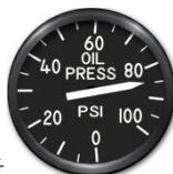
有一个油压表，显示发动机滑油压力，单位为磅/平方英寸（PSI）。仪表和指示器由三相交流电供能。
