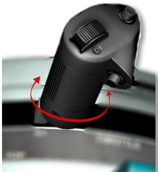
流阀中（无法用鼠标旋转节流阀；必须操作键盘或操纵杆）。扭转手柄改变了距离选择旋钮的参数，进而影响陀螺进动速率。投射有瞄准具掩模图像的陀螺齿轴玻璃根据陀螺仪的操作参数进行更大或更小的角度偏转。瞄准具掩模图像转变为视场，使得飞行员必须沿着目标速度矢量“移动”飞机（和机枪）的X轴，以便使掩模图像维持在目标上。瞄准点偏移取决于上述因素。
