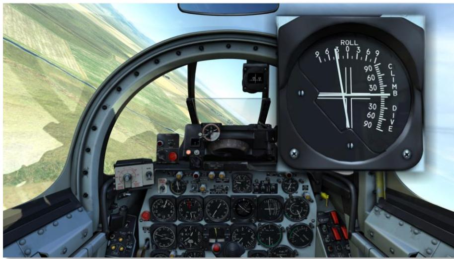
图 11. 2 LABS 横滚指示器读出 35 度左侧横滚
