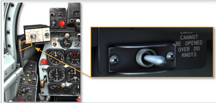
图 3.8 座舱盖开关
