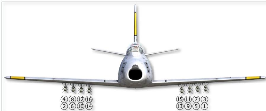
图 6.13 火箭弹发射顺序 (16 HVAR)
