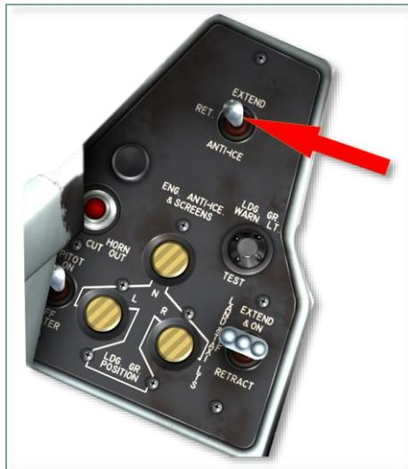
图 5.9 发动机保护开关
