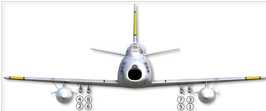
图 6.14 火箭弹发射顺序 (8 HVAR)
