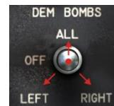
7. 操作爆破炸弹顺序选择开关 (ALL—LEFT—RIGHT) 选择释放顺序。确保破片炸弹选择开关处于 OFF 位置（如果在模拟中实现）。
