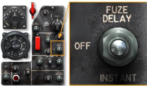
火箭弹引信 (解除保险) 开关 (FUZE DELAY—OFF—INSTANT) 用于设置火箭弹引爆延迟。当开关处于即时状态时，火箭弹弹头引信会在受到撞击时提供起爆。当开关处于 **DELAY** 时，内部引信被解除保险，在撞击后引起相对较短的爆炸延时。如果开关置于 **OFF** 位置，则火箭弹爆炸由内部引信起爆。如果火箭弹被抛弃，他们的引信是处于保险的。
