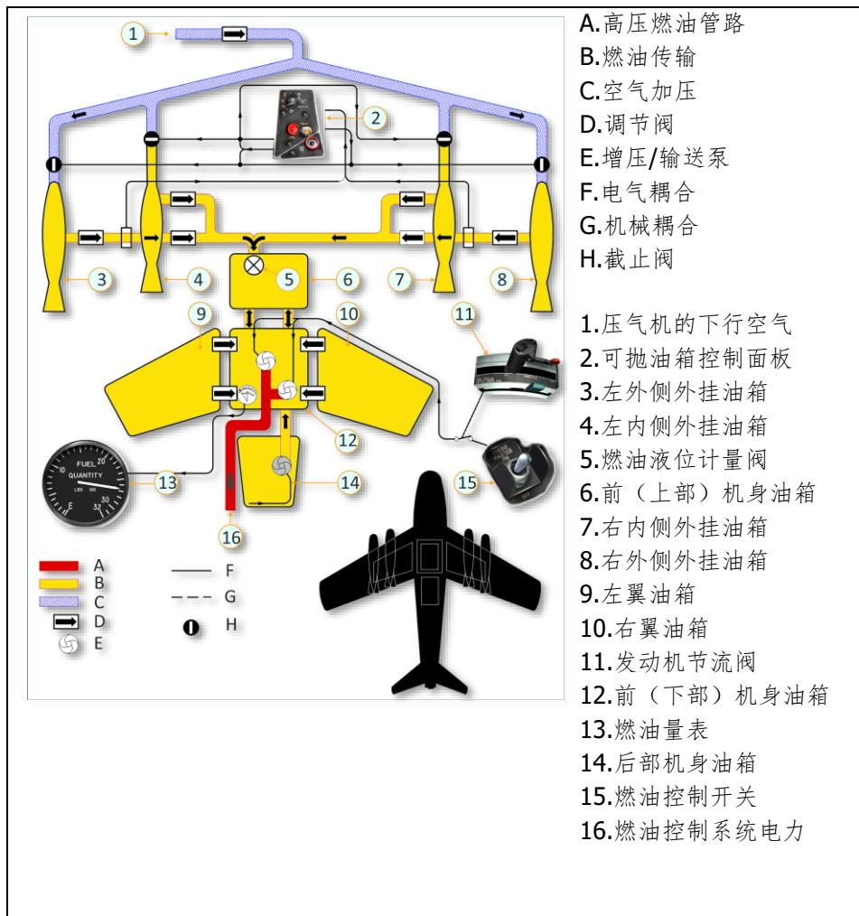
图 5.4 飞机燃油系统略图
