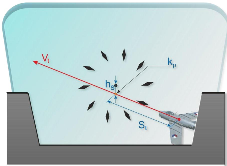
图 6. 20 无计算机的瞄准具图像（瞄准具掩模静止不动）
