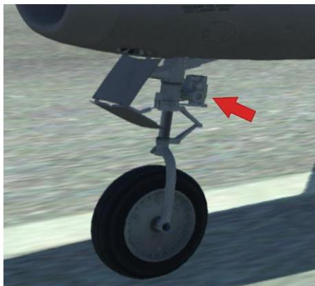
图 4.5 前轮转向机构
