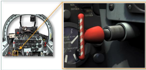
受保护的紧急抛弃手柄具有两个确定的释放位置，并允许选择性地机械释放外部负载。顺时针旋转手柄至止动挡块处，然后尽可能将其拉出（约 4 英寸），仅释放外侧可抛油箱。当手柄没有被旋转就被完全拉出（大约 10 英寸）时，所有可抛油箱（或所有外部负载）同时被释放至其。将紧急抛弃手柄顺时针旋转到止动挡块处，然后尽可能地拉出手柄（大约 4 英寸），当挂载了无鳍的 200 加仑油箱时，在油箱挂架中产生一次电脉冲，激活爆炸装药强行抛弃油箱。
