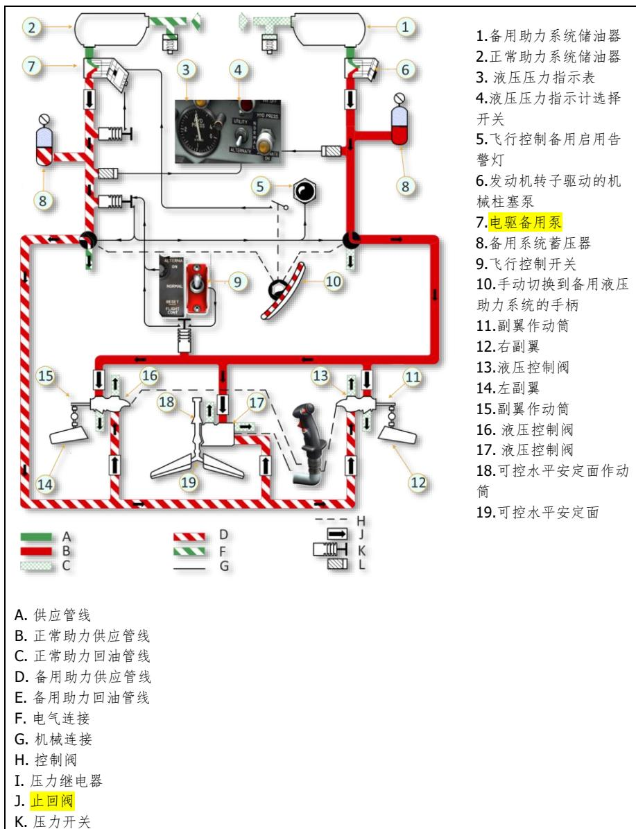
**L. 压力传感器****图 5.8 液压助力系统略图 (修正补全)**
