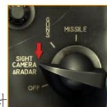
当机枪-导弹选择开关设置在除 OFF 外任意位置时，雷达设备开始运行。
