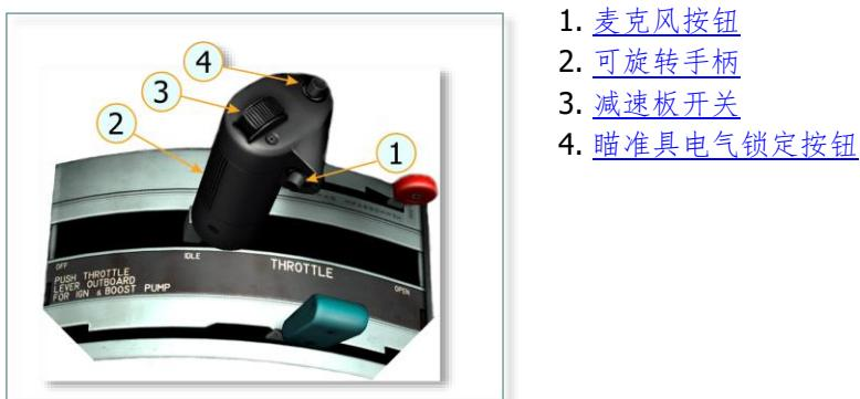
图 4.4 发动机节流阀扭杆上的控制
