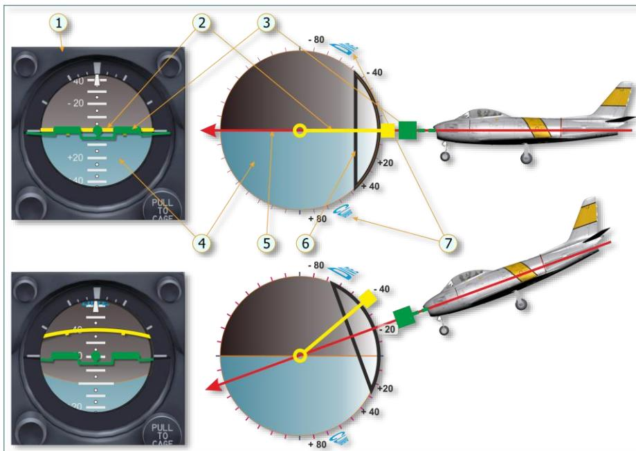
图 4.7F-86 人工地平线操作原理
