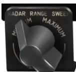
(6) 雷达扫描距离变阻旋钮。该旋钮用于改变雷达输出功率，从而减小或增加目标探测距离。
