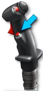
在检探测到目标后，雷达锁定目标，开始测量锁定目标的距离并将测量数据提供给雷达。为了超限雷达锁定并将雷达移到另一个目标（如果有多个目标），飞行员需要暂时按下并释放控制杆上的雷达目标选择按钮（**[Enter]**），在这种情况下，雷达将放弃先前锁定的目标，将自动重置/循环并从最小扫描距离开始扫描。这允许重新锁定最近（最关键）的目标，同时瞄准具自动切换到 GUN 模式（连接到射击分系统）。
