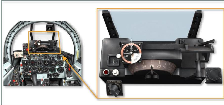
磁罗盘。传统的磁罗盘（图 4. 1,4）是一种用于确定飞机磁航向的备用装置。安装它是为了在仪器或电气系统发生故障时进行导航。磁罗盘的照明由右前控制台上的罗盘灯开关控制，而亮度由控制台照明变阻器控制。
