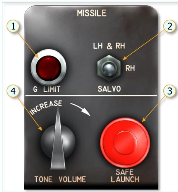
1. G 限制告警灯（超出导弹发射 G 限制）
