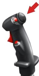
配平完成通过操作配平开关后释放，或减少驾驶杆载荷后驾驶杆定位在保持期望的飞行姿态。向两侧按住正常配平开关给电动横向配平舵机通电。向前或向后按住正常配平开关给电动纵向配平舵机通电。配平舵机在通电时，重新定位人感系统的弹簧。反过来，弹簧施加必要的力以建立杆的新的中置（空载）位置，消除或减少驾驶杆负载。正常配平电路由主要总线供电。
