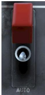
位置：SINGLE – OFF – AUTO。当选择器处于 **SINGLE**（上位）时，每次在驾驶杆上按下炸弹—火箭弹释放按钮时，就会发射一枚火箭弹。当选择器处于 **AUTO**（下位）状态时，释放按钮处于按下位置，火箭弹按序点火，直到所有火箭弹都被发射。如果选择器处于 **OFF**（中置），按下释放按钮将不会发射火箭弹。如果“火箭弹抛离就绪”打开（上位），火箭弹释放选择开关将不起作用：如果那样的话，所有火箭弹会同时发射。
