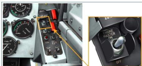
发动机主开关（燃油自动化系统主开关）在右前面板上部的位置
