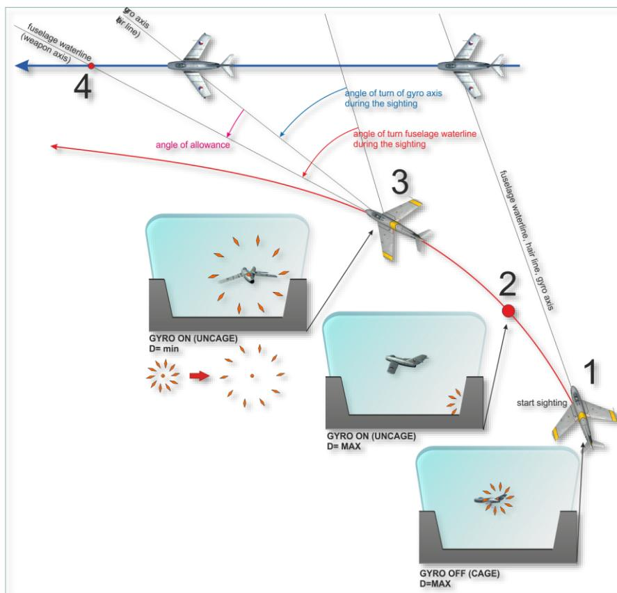
图 6. 21 用陀螺瞄准具进行瞄准
