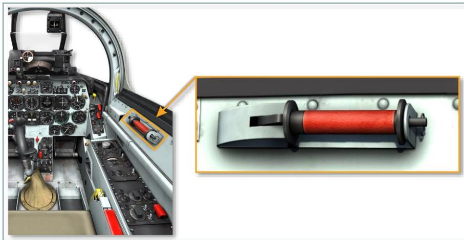
图 3. 11 座舱盖手动操作手柄
