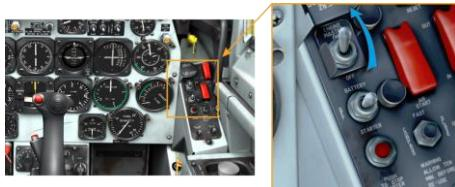
3. 设置 BATTERY-OFF-STARTER 选择开关到 STARTER (1) — [RAlt + RShift + N] (短暂), 然后到 BATTERY (2) — [RAlt + RShift + H]
