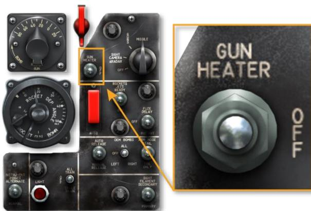
4. 在中央基座上的机枪枪管加热开关（预防机枪在低温结冰或高湿度条件下受到干扰）
