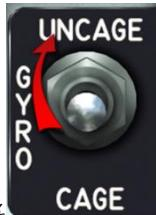
准确，并通过将开关置于 UNCAGE 来解锁 LABS 陀螺仪。
