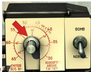
置时，根据 MPC 单元中的控制旋钮位置，瞄准具掩模电气锁定在从 0 至 174 密耳的角度。
