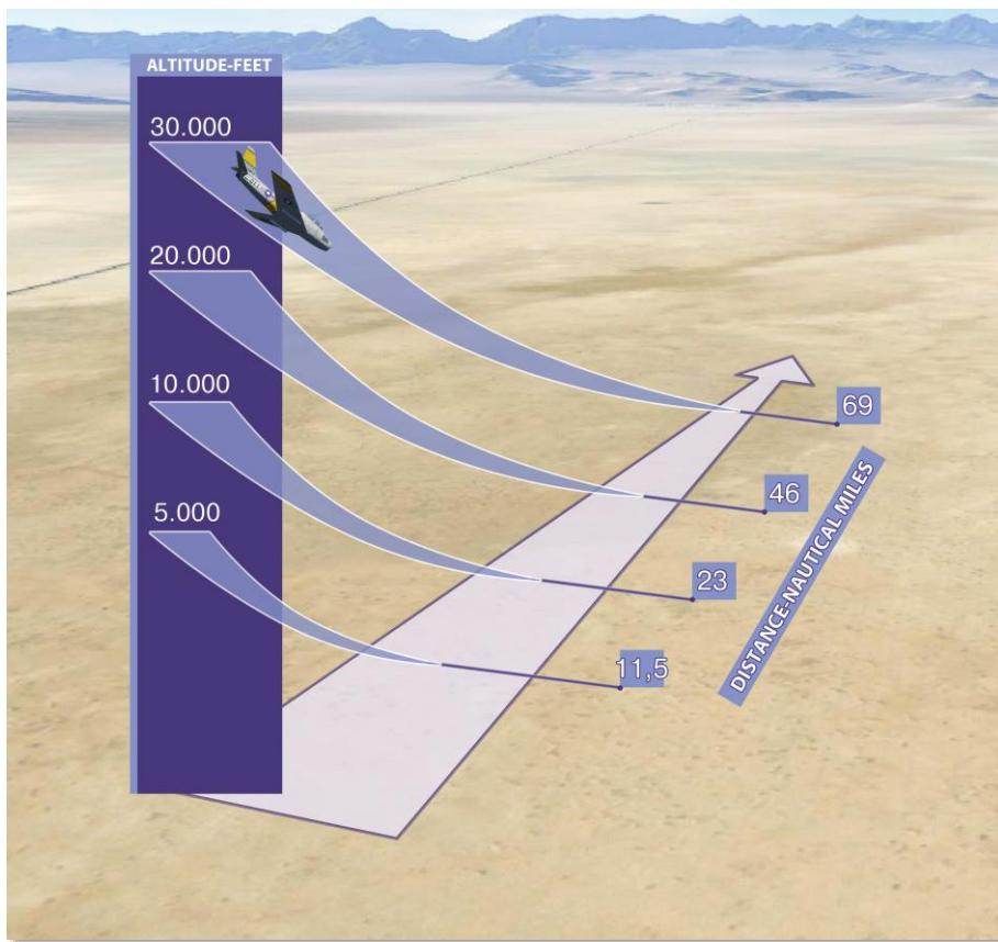
图 10. 2 发动机关闭下的滑翔距离 (nm) , 取决于初始高度 (FT)
