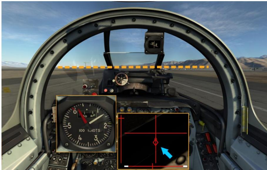
图 8.2 在飞机离开跑道前驾驶杆和座舱盖的位置
