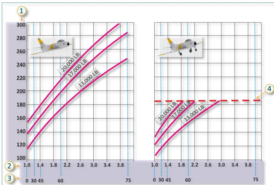
图 10.4 失速速度（左一起落架和襟翼上位，右·起落架和襟翼下位）
