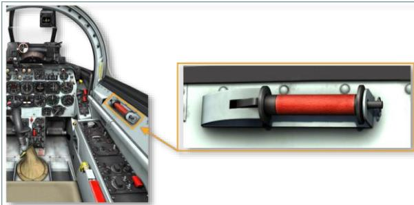
中央基座（武器面板）。位于中央基座上的武器面板（图 4.1,9）包含各种瞄准具功能和武器模式控制。[请参阅此处了解详情。](#)
