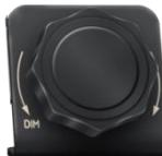
(4) 瞄准具掩模调光控制旋钮。该旋钮用于调节瞄准具掩模照明的强度。在不操作瞄准器时应将 **DIM** 放置在 **DIM** 位，以防止在电压波动时损坏掩模灯泡。
