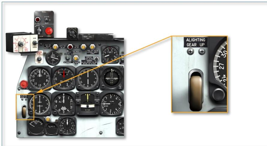
位于仪表板左侧的起落架手柄，电气控制（通过主要总线电源）起落架和起落架舱门液压选择阀。将手柄向上或向下移动使通用液压系统对起落架相应地施压。当起落架放下并锁定，且飞机机轮承重时，地面安全开关防止控制手柄无意中移动到 **UP** 时的起落架收起。起落架整流舱门不受安全开关控制，因此当把手向上移动时，它们将按照正常顺序打开。这将导致地面操作下，起落架手柄处于错误位置 (**UP**) 的告警。
