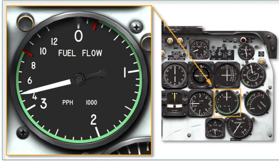
位于仪表板上的燃油流量计显示燃油流量，每小时千磅（PPH，或磅/小时）。其监控不同飞行模式下的适当燃油流量。
