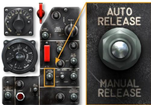
将选择开关置于 **MANUAL RELEASE**，通过按下驾驶杆上的炸弹—火箭弹释放按钮释放炸弹。如果选择开关设置于 **AUTO**，当满足炸弹投放后能命中目标的飞机飞行条件（俯仰角，速度，高度和 G 载荷）时，飞行员按下并保持驾驶杆上的按钮，炸弹自动释放；释放点由任务计算机计算。对于破片炸弹（尚未在模拟中实现），选择开关应处于 **MANUAL RELEASE**。
