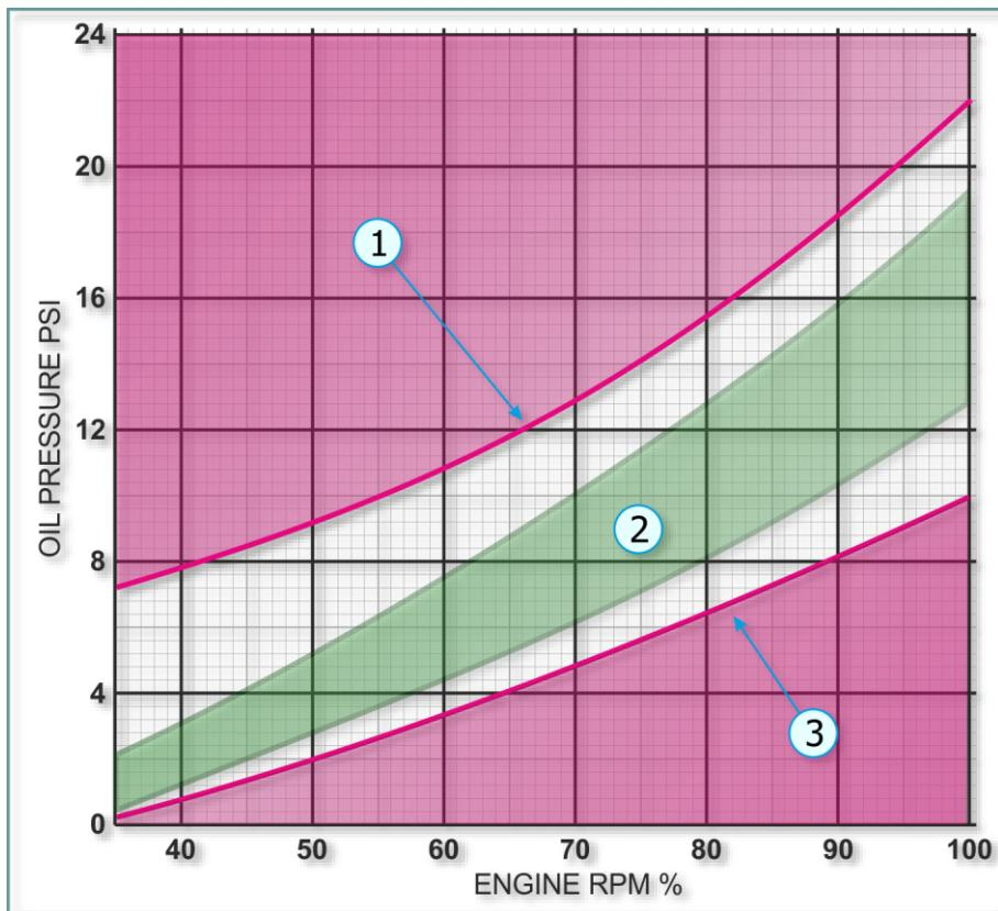
图 9.1 发动机机滑油压力限制
