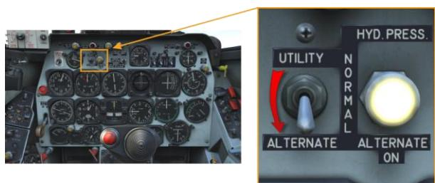
当连接外部动力装置时，备用飞行控制助力系统的柱塞泵将启动。系统中的压力应升至工作压力（约 3000 PSI）。
