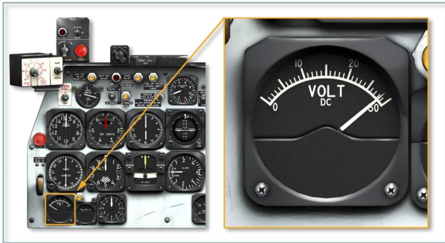
位于仪表板左下角的电压表直接指示发电机输出的电压，即它表示直流电路中的实际电压。
