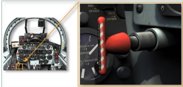
(10) 氧气调节器面板。D-2 (A) 增压式呼吸设备，按需稀释氧器调节器安装在左前控制台的内侧面，控制氧气系统。有关更多信息，请参见 [5.9](#)。
