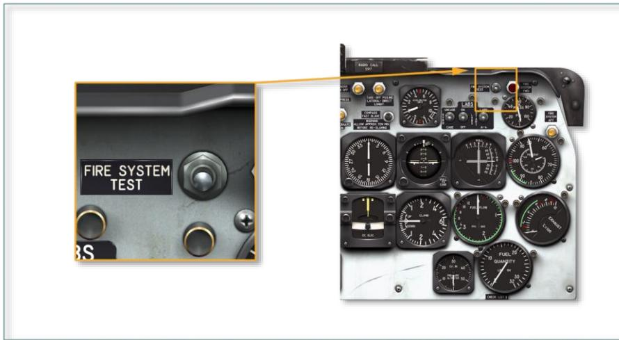
通过火情告警灯测试按钮可检查发动机段火灾探测器系统的连接和火灾警报灯的操作。为进行测试，请按住按钮 **10** 秒钟——两个灯都应在 **10** 秒钟内亮起。
