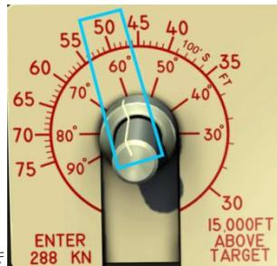
所选择的俯冲角度 (在示例中，俯冲角度为  $60^{\circ}$ ，在海拔 15,000 英尺，释放速度 288 节下，释放高度为 5,000 英尺)。
