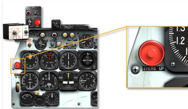
紧急起落架收回是一种设计为在起飞期间（在现实中）发动机失效下收起的起落架的系统。这用于在短跑道上处于抬轮速度的发动机故障，这样没有足够的空间及时停止。出在地平面时的早期弹射座椅无法保证生还。因此，紧急起落架的收回设计是为了在起飞时失去发动机后给飞行员一个机会。当按下紧急起落架收回按钮时，起落架会以破坏方式穿过起落架舱门（未建模）。紧急收回有自己一套的完整的液压管路系统，它没有向起落架舱门施加任何压力以打开它们（我们的模型中，我们已完成的液压管路系统里没有该建模）。
