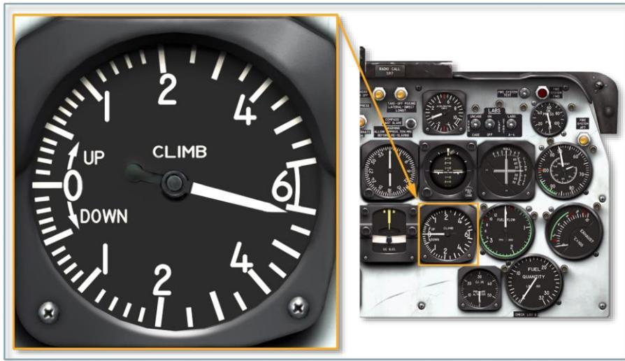
垂直速度表 (VVI) 表示飞机的爬升或下降速度。
