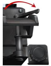
2. 将瞄准具机械锁定杆置于 UNCAGED (右侧)。
