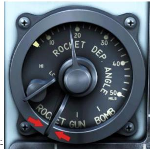
6. 在瞄准具选择单元上: 将瞄准具功能选择杆置于 ROCKET [LCtrl + D];
