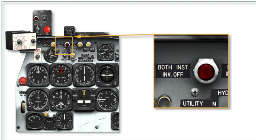
该红色告警灯指示两个三相逆变器都发生故障。如果备用三相逆变器发生故障（通过仪表电源开关选择后），两个仪表逆变器故障告警灯将亮起。位于仪表板上的灯是推入式测试型，由主要总线供电。
