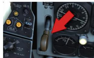
驾驶舱内有一个位于仪表板底部的起落架控制手柄。
