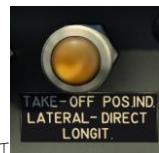
3. 将升降舵配平调整片设置为起飞位置：为此，选择起飞配平位置指示灯，然后按住 [RCtrl + ;]。驾驶杆位置指示器将开始缓慢向下移动。一旦达到起飞配平位置，灯泡将短暂亮起并熄灭。现在升降舵配平调整片设置在起飞位置。
