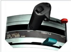
发动机节流阀机械连接到燃油关断阀和主燃油控制器与紧急燃油控制器([3.2.3](#))。当主开关接通时，向发动机启动系统和燃油关断阀供电。然后，当节流阀从 OFF 变为 IDLE 时，燃油关断阀打开。燃油供应给发动机起动系统和发动机本身（点火系统在转速（RPM）达到约 23% 时自动关闭）。当发动机运行时，节流阀位置确定目标转速（RPM）。
