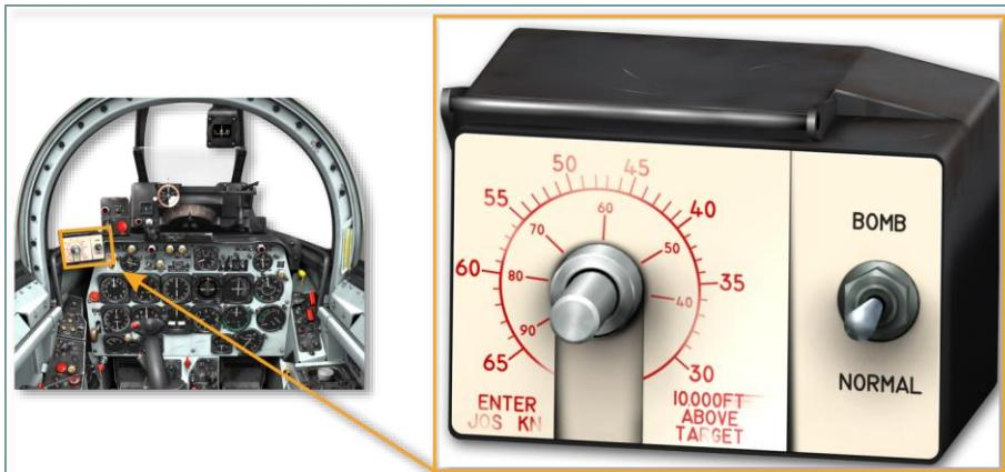
导弹控制面板。导弹控制面板（图 4.1, 2）包含 GAR-8 空对空红外制导导弹系统的四个控件。[详情参见这里](#)。
