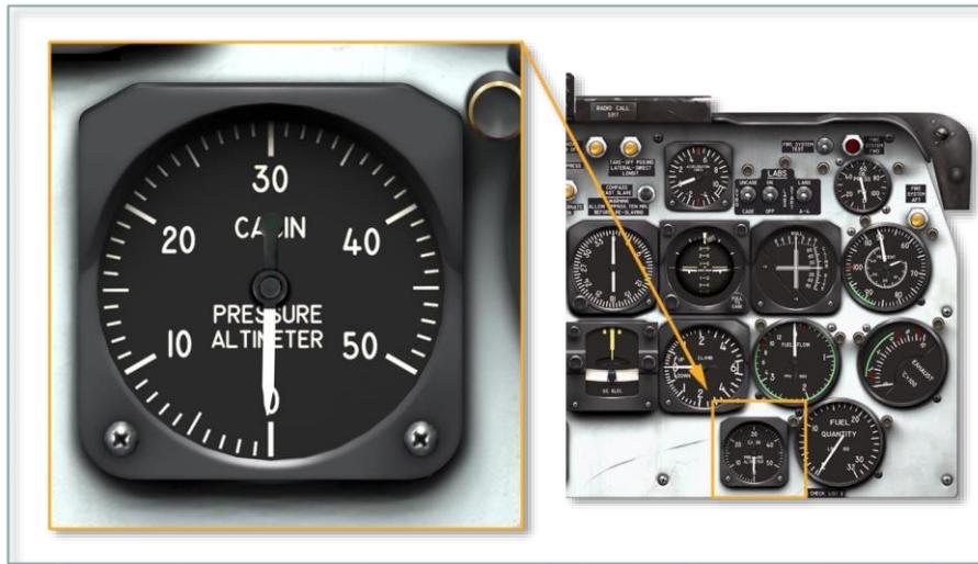
位于仪表板上的 MA-1 驾驶舱压力高度计，表示驾驶舱的压力高度，以千英尺为单位。
