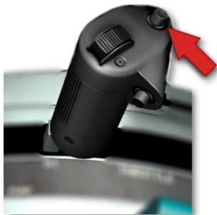
同时瞄准具掩模图像稳定。在最初接近目标的机动中图像稳定是有必要的，以限制陀螺仪的偏移。与瞄准具机械锁定杆不同，节流阀上的按钮允许飞行员将手放在控制器上，这在机动空战中尤为重要。这也使得在释放按钮后可立即准备战斗（它开始与计算机一起工作）。
