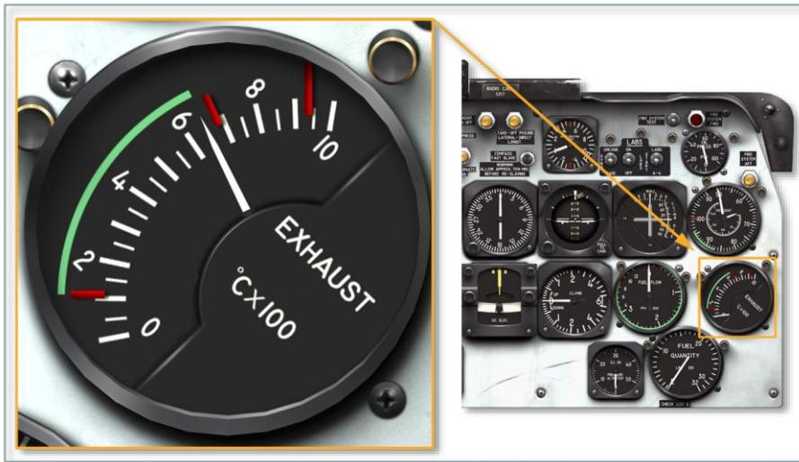
位于仪表板上的排气温度 (EGT) 计显示发动机排气温度 (摄氏度) ——衡量发动机健康状态及其当前运行模式的重要指标。仪表从安装在尾喷管前部的卡口式热电偶接收读数。温度表系统是自发电型的，因此不需要来自飞机电气系统的电力。
