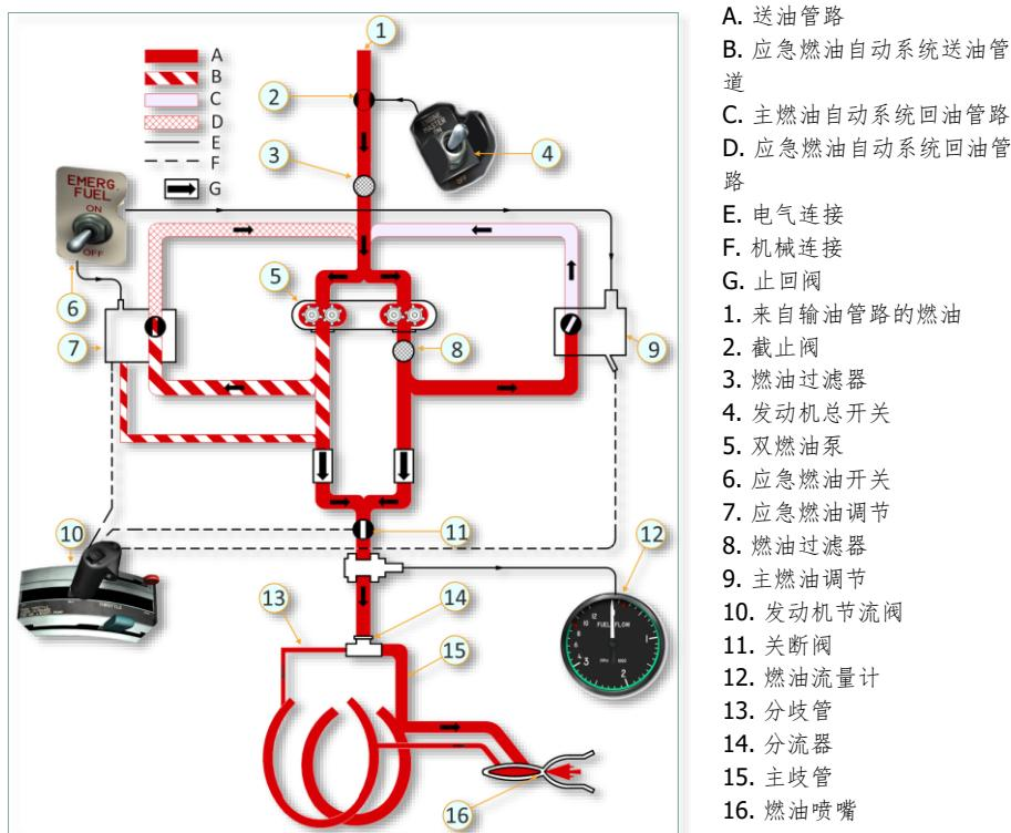
图 3.14 发动机燃油自动化系统
