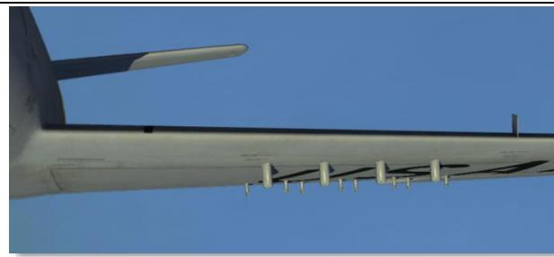
火箭弹发射器（每侧半翼下 4 个）
