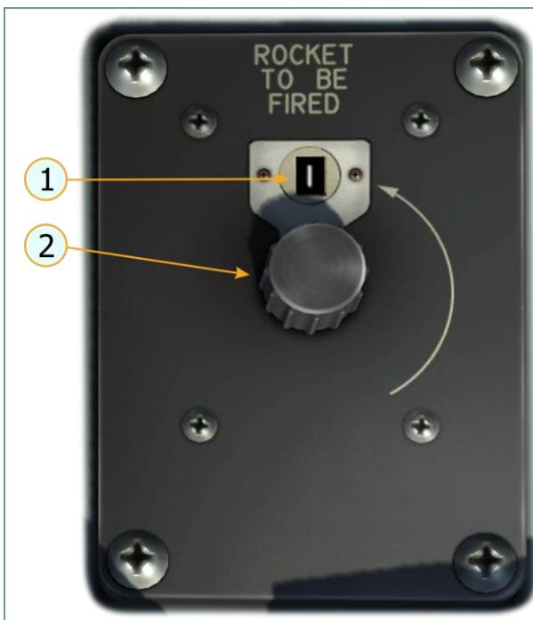
1. 第一发火箭弹发射装置的发射序号
