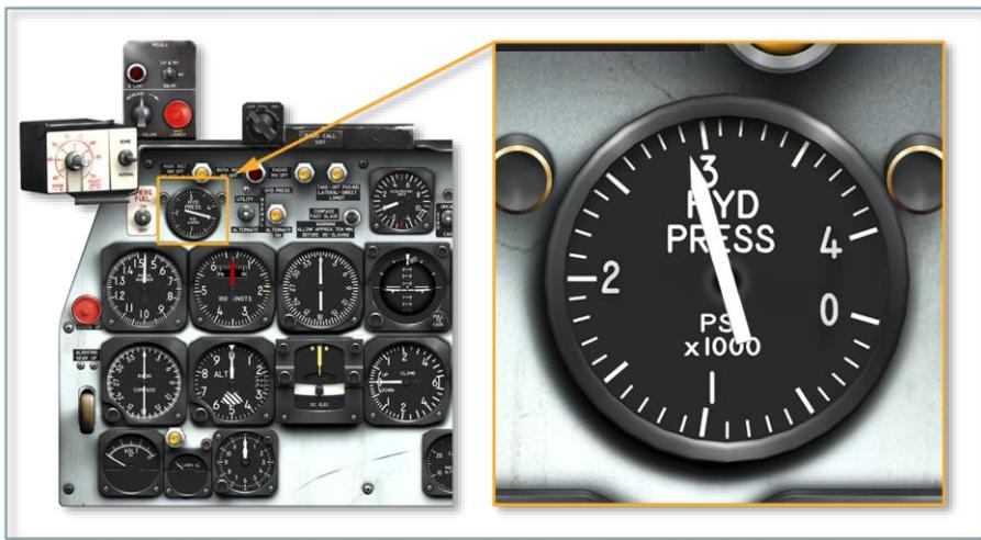
标有 **HYD PRESS** 的液压表位于仪表板的左上方。该仪器指示由液压仪表选择开关选择的液压系统中流体压力，以磅/平方英寸（PSI）为单位。1,000 PSI 约等于 70 kg /cm<sup>2</sup>。该仪表从 0 到 4,000 PSI，刻度以 100 PSI 间隔。
