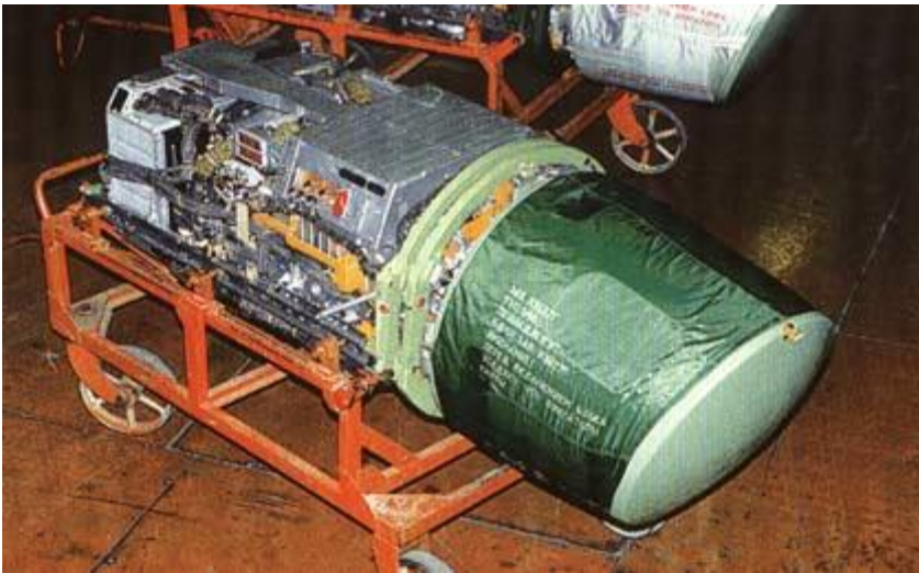
Abbildung 5-3: N019 Radarsystem einer MiG-29
