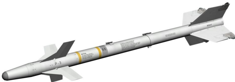
Abbildung 6-17: AIM-9P Sidewinder Rakete
