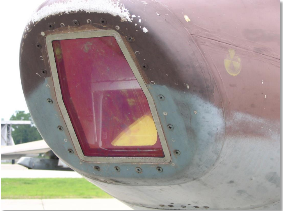
Abbildung 5-2: Laserentfernungsmesser und Zielbeleuchtungssystem "Klen" an einer Su.25
