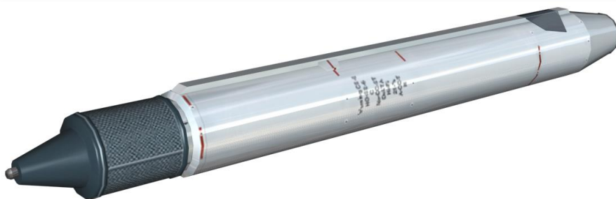
Abbildung 7-25: Die S-25 ungelenkte Rakete im Abschussrohr.
