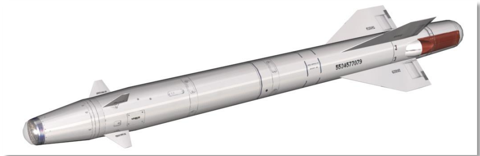
Abbildung 7-1: Die Kh-25ML (AS-10 "Karen") taktische Luft-Boden Rakete
