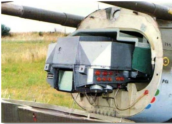
Abbildung 5-7: Su-25 Laserentfernungsmesser / Zielbeleuchtungssystem "Klen-PS"
