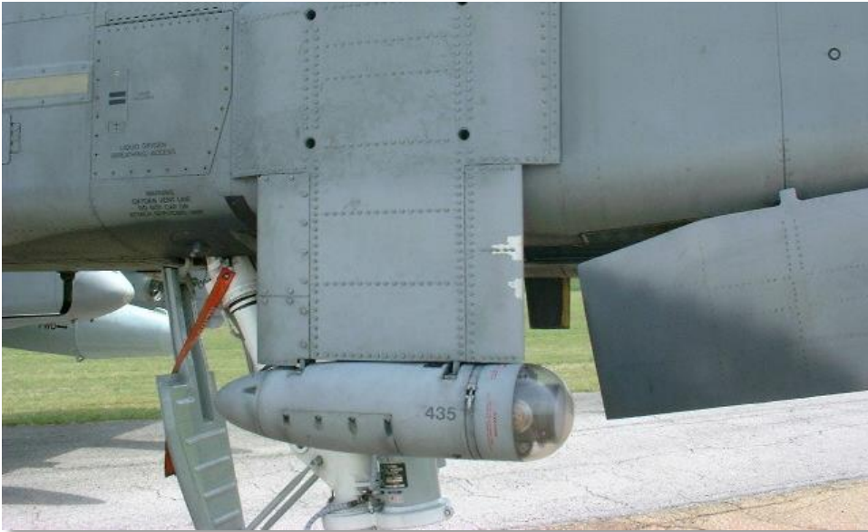
Abbildung 5-1: A-10 Pave Penny Zielbehälter
