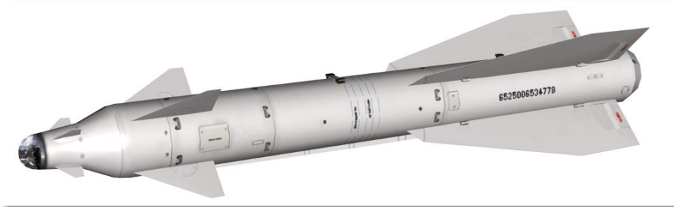
Abbildung 7-2: Die Kh-29L (AS-14 "Kedge") taktische Luft-Boden Rakete
