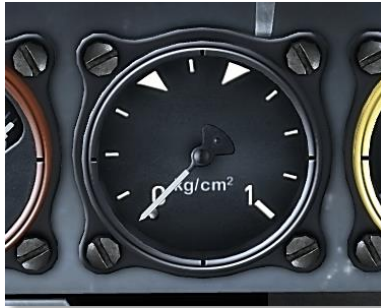
Abb. 18: MW-50 Druckanzeiger im unteren Hauptgerätebrett
