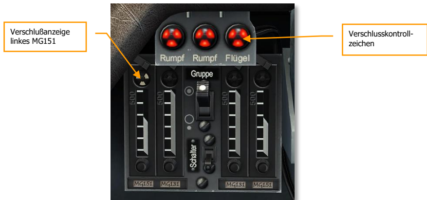
Abb. 50: SZKK 4 Schusszähler und Kontrollkasten
