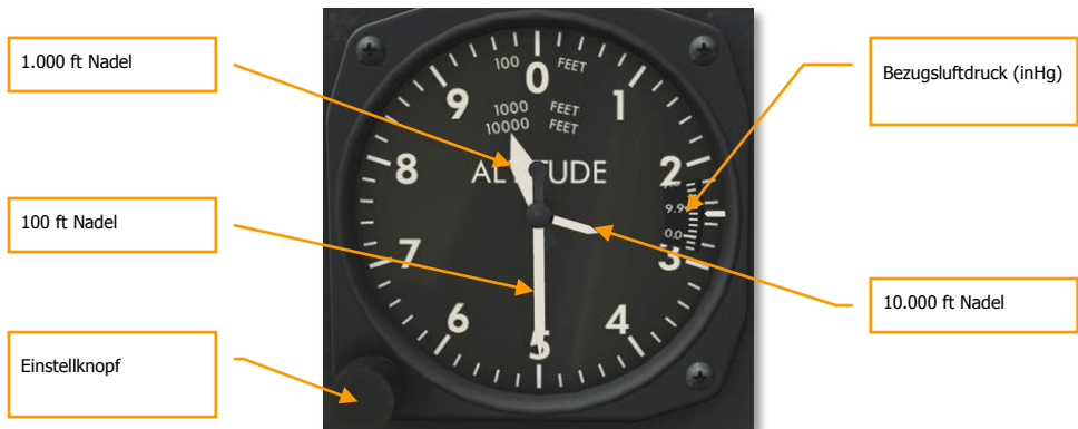
Abbildung 44: AN5760-2 Höhenmesser, angezeigte Flughöhe 29.500 ft.
