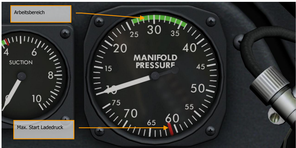
Abbildung 83: Max. Start-Ladedruck – 61 in. Hg (155 cm Hg) (rote Markierung). Arbeitsbereich 26...36 in. Hg (66,04 - 91,44 cm Hg) (grüner Bereich).
