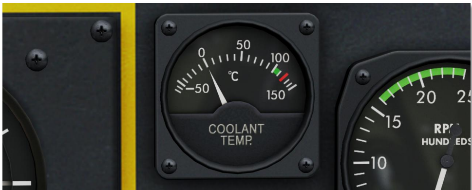
Abbildung 87: Max. Kühlmitteltemperatur 121°C (250°F), Arbeitsbereich 100...110°C (212...230°F)
