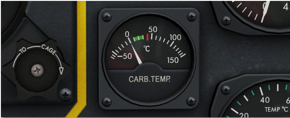
Abbildung 88: Erwünschte Vergasereinlasstemperatur 15...30°C (59...86°F), Maximum 40°C (104°F)
