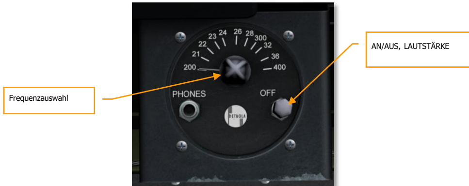
Abbildung 79: BC-1206 "Detrola" Funkentfernungsmesser
