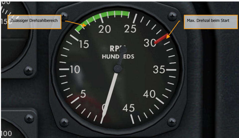
Abbildung 85: Max. Startdrehzahl 3000. Arbeitsbereich 1600...2400.
