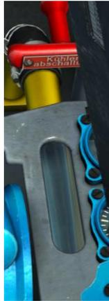
**Abb. 101: Schauglas in der Kraftstoffleitung**
