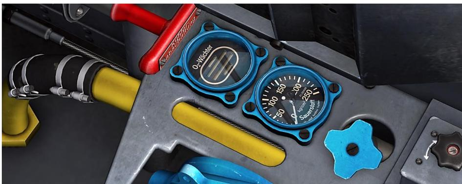
**Abb. 48: O<sub>2</sub>-Wächter und Druckmesser**
