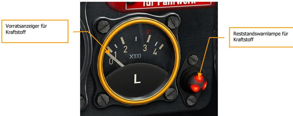
**Abb. 85: Kraftstoffvorratsanzeige und Reststandswarnlampe**
