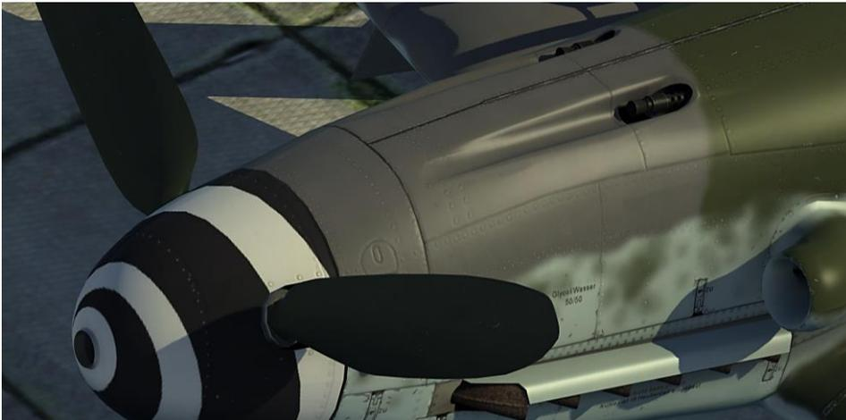
**Abb. 56: MK 108 Motorkanone und zwei MG 131 Maschinengewehre über dem Motor**
