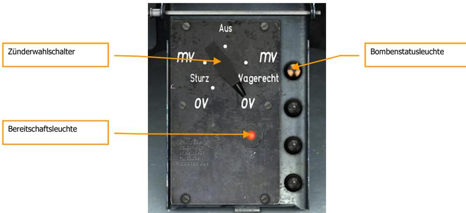
**Abb. 90: Hilfsgerätetafel mit Zünderschaltkasten (ZSK 244K)**
