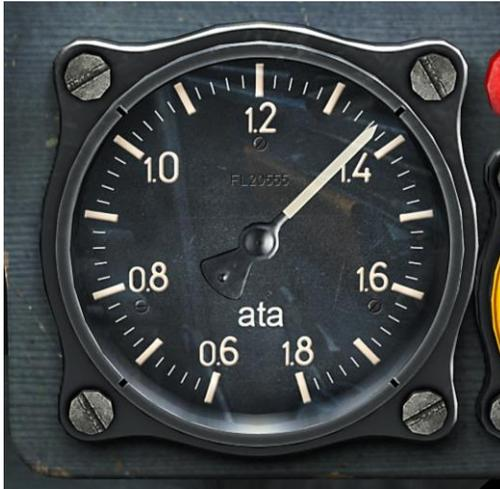
**Abb. 87: Ladedruckanzeiginstrument**
