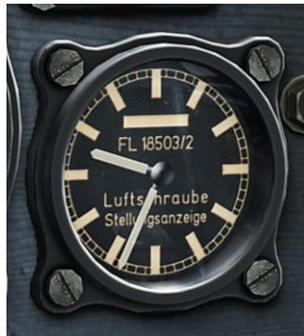
**Abb. 84: Luftschrauben-Stellungsanzeiger in 9:34-Uhr-Position**
