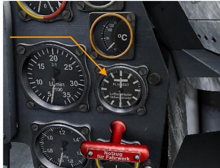
Stellen Sie den Schalter Automatik für Luftschraubenstellung in die hintere (automatische) Position. Der Luftschrauben-Stellungsanzeiger sollte automatisch nach 12:30 wandern und dort verbleiben.
