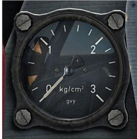
**Abb. 32: Methanol-Wasser Druckanzeiger**
