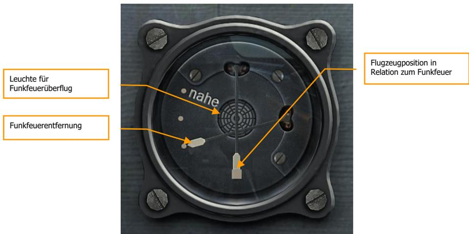
**Abb. 88: AFN-2 Anzeigergerät für Funknavigation**
