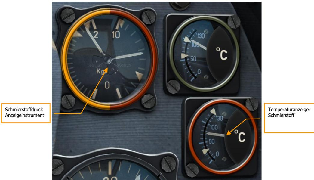
**Abb. 44: Schmierstoffdruck (rechts) und Schmierstofftemperatur Anzeigeeinstrumente**
