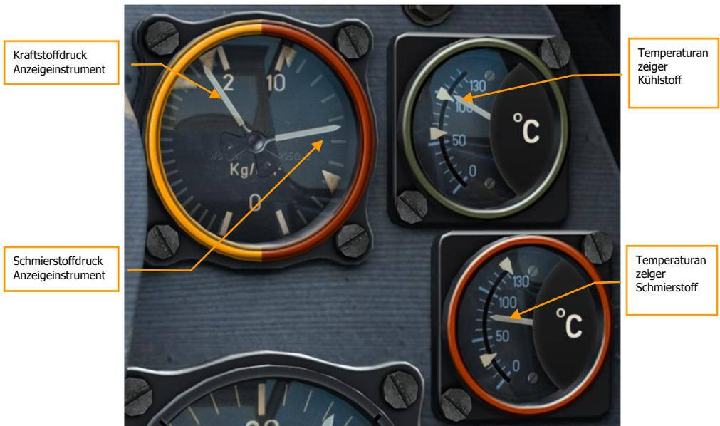
**Abb. 82: Doppeldruckmesser für Schmier- und Kraftstoff, Temperaturanzeiger für Kühlstoff und Schmierstoff**
