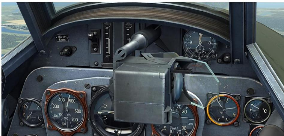
**Abb. 67: Revi 16B in geklappter Position**
