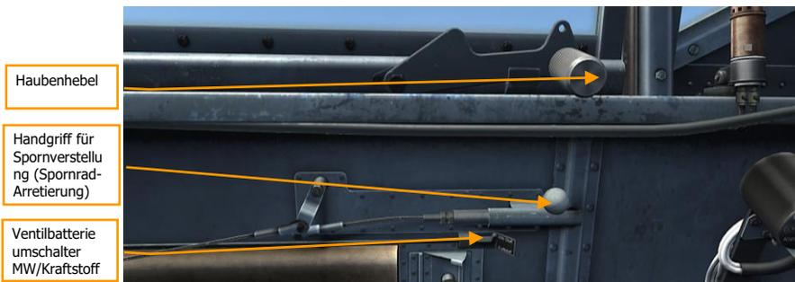
**Abb. 91: Haubenhebel, MW/Kraftstoff Ventilbatterieumschalter und Spornradverriegelung**
