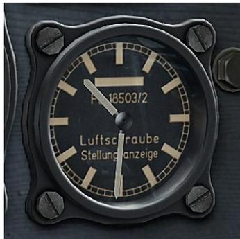
**Abb. 35: Stellungsanzeige Luftschraube zeigt 10:30 oder 38 Grad Steigung**
