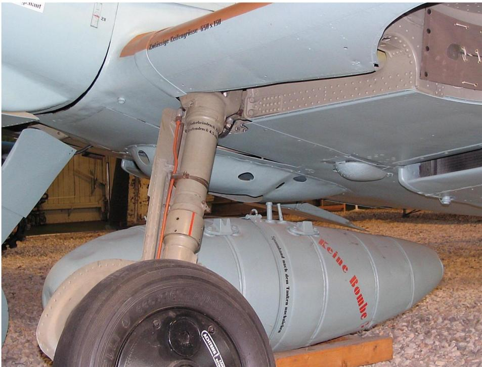
**Abb. 4: Fahrwerk einer Bf 109 G-2**
