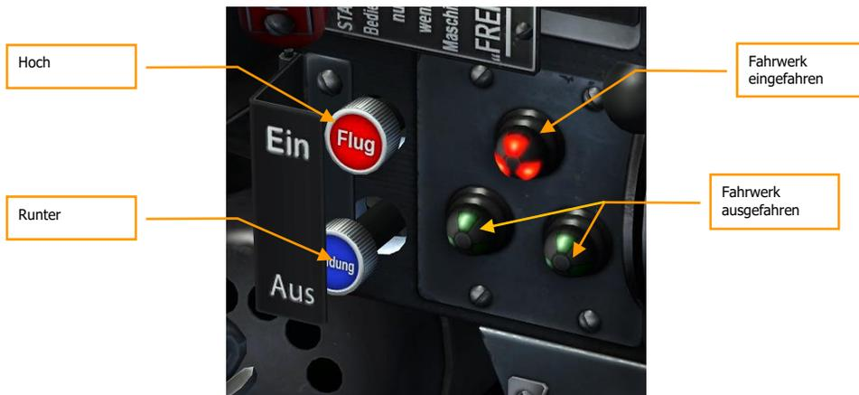
**Abb. 76: Fahrwerksschalter und Fahrwerksanzeige**
