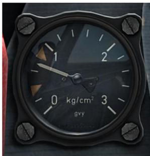
**Abb 72: Methanol-Wasser-Druckanzeigeeinstrument**
