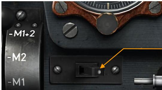
**Abb. 33: MW-50 Schalter**
