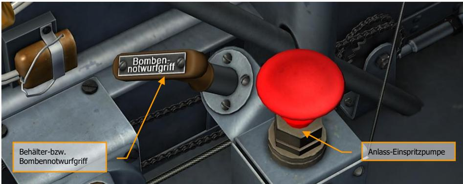
**Abb. 94: Bedienungen für Notfallbeladungsabwurf und Anlass-Einspritzpumpe**
