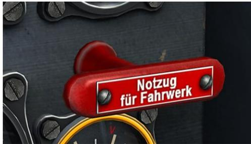
**Abb. 77: Fahrwerksnotfallentriegelung**
