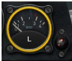
**Abb. 38: Vorratsanzeigegerät und Reststandswarnlampe**
