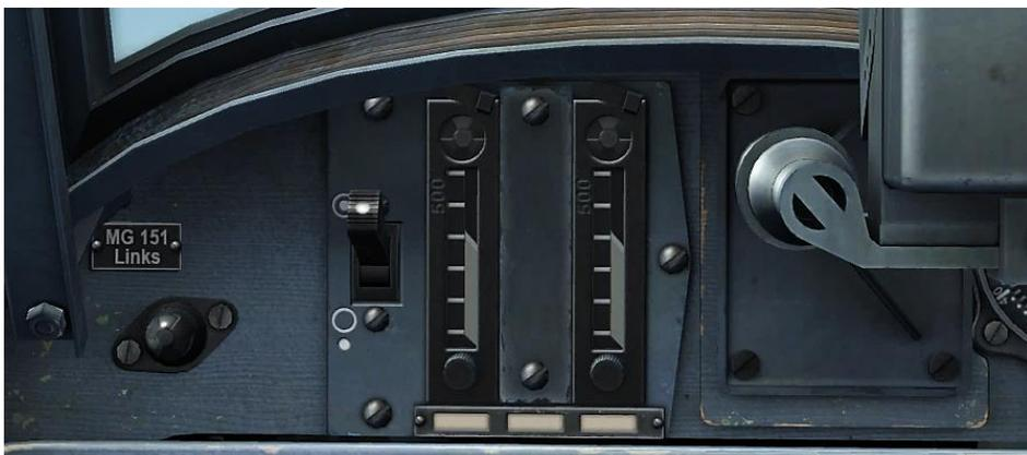
**Abb. 57: SZKK 4 Schusszähler und Kontrollkasten**
