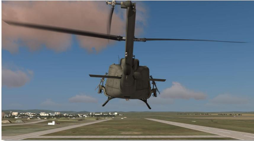
Abbildung 9-11: Schräglage des Hubschraubers während der Geschwindigkeitsreduzierung.
