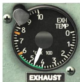
Der Abgastemperaturanzeiger befindet sich im oberen mittleren Bereich des Instrumentenbretts und ist mit EXHAUST beschriftet. Die angezeigte Temperatur wird von den im Abgasrohr angebrachten Sensoren ermittelt. Die Anzeige wird in Grad Celsius dargestellt. Das System versorgt sich selbst mit elektrischer Energie.
