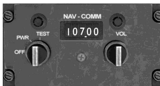
Abbildung 7-2-1: AN/ARN-82 VHF/ILS Navigationskonsole
