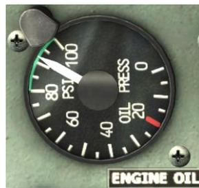
Der Triebwerksöldruckanzeiger befindet sich im zentralen Bereich der Instrumententafel und ist als OIL PRESS gekennzeichnet. Die Anzeige erhält den aktuellen Druck vom Triebwerksöldrucksensor und zeigt diesen in PSI (pounds per square inch, Pfund pro Quadratzoll) an.
