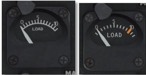
Im mittleren unteren Instrumententafelbereich sind zwei Voltmeter angebracht. Der als MAIN GEN bezeichnete Voltmeter zeigt die Hauptgeneratorlast in Prozent an, der als STBY GEN bezeichnete Voltmeter die Notfallgeneratorlast – ebenfalls in Prozent. Beide Voltmeter funktionieren nur bei laufenden Generatoren.
