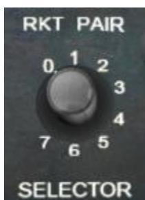
Nutzen Sie den PAIR SELECTOR Schalter um die Anzahl der abzufeuern Raketenpaare einzustellen.
