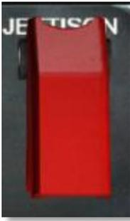
Ein elektrischer Notabwurfschalter für die Raketenwerfer.
