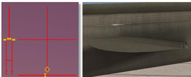
**Abbildung 4-4: Position des synchronisierten Höhenleitwerks bei vollständig zurückgezogenem Steuerknüppel (+1.28 Grad).**
