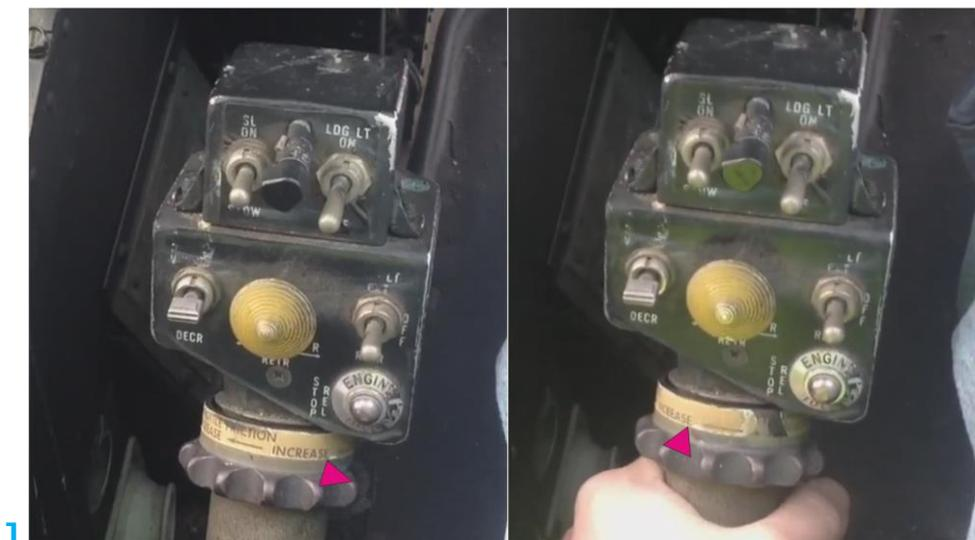
Abbildung 9-2: Position bei KOMPLETT ZUGEDREHT und an der LEERLAUFSPERRE
