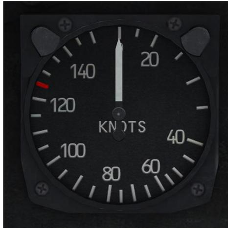
Der Fahrtenmesser des Piloten und Copiloten zeigt die angezeigte Fluggeschwindigkeit (IAS) in Knoten an. Die Anzeige zeigt in 5er oder 10er Schritten die Fluggeschwindigkeit zwischen 0 und 150 Knoten an. Ein rotes Farbband markiert den Gefahrenbereich bei 124 Knoten.
