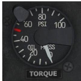
Der Drehmomentanzeiger befindet sich im zentralen Bereich des Instrumentenbretts und ist mit TORQUE gekennzeichnet. Der Anzeiger ist mit einem Transmitter verbunden, der ein Teil des Triebwerkölsystems ist. Der Wert wird in Pfund pro Zoll (PSI) des auf den Hauptantriebsstranges anliegenden Drehmomentes angezeigt. Das maximal erlaubte Drehmoment wird mit einem roten Strich dargestellt (hier 50 PSI).
