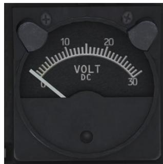
Das DC-Voltmeter befindet sich im zentralen Bereich der Instrumententafel und ist mit VOLT DC beschriftet. Das Gerät zeigt die anliegende Spannung derjenigen Gleichspannungsquelle an, die mittels des VM (Voltmeter)-Wahlschalters in der Deckenkonsole ausgewählt wurde.
