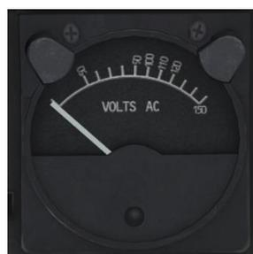
Der Wechselstromvoltmeter befindet sich im zentralen Bereich der Instrumententafel. Hier wird die vom Umrichter (Haupt- oder Ersatzumrichter) erzeugte Spannung angezeigt. Die angezeigte Spannung sollte immer zwischen 112 und 118 Volt AC liegen.
