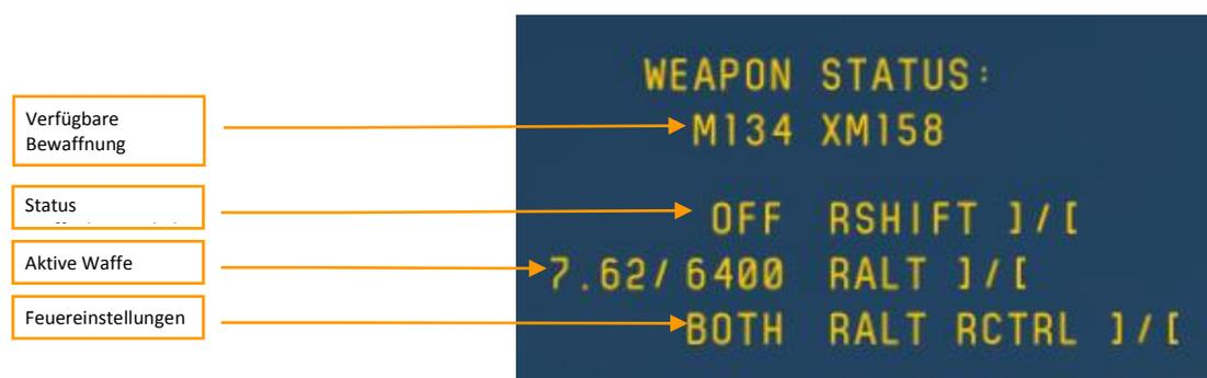
Abbildung 10-2: Waffenstatusanzeige in AUS-Position (Waffen gesichert), gewählte Waffe 7.62 (M134) mit 6400 Schuss Munition, BOTH zeigt an, dass beide Geschütze simultan abgefeuert werden.
