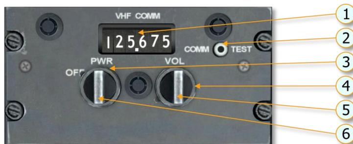
Abbildung 7-1-3: VHF Bedieneinheit C-7197/ARC-134
