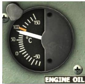
Der Triebwerksöltemperaturanzeiger befindet sich im zentralen Bereich der Instrumententafel und ist mit ENGINE OIL beschriftet. Das Gerät zeigt die Temperatur des Triebwerköls am Triebwerksöleinlass in Grad Celsius an.
