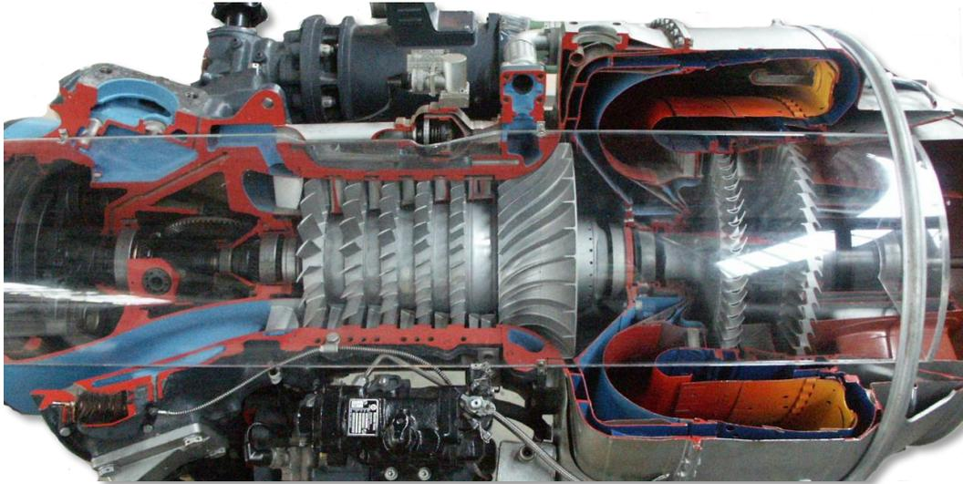
Abbildung 2-7: Interner Aufbau der T53-L-13B Gasturbine (2 von 2)
