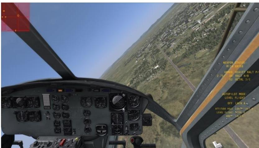
Abbildung 6-7: Position der Autopilot- und Waffensystem-Statusanzeige auf dem Bildschirm
