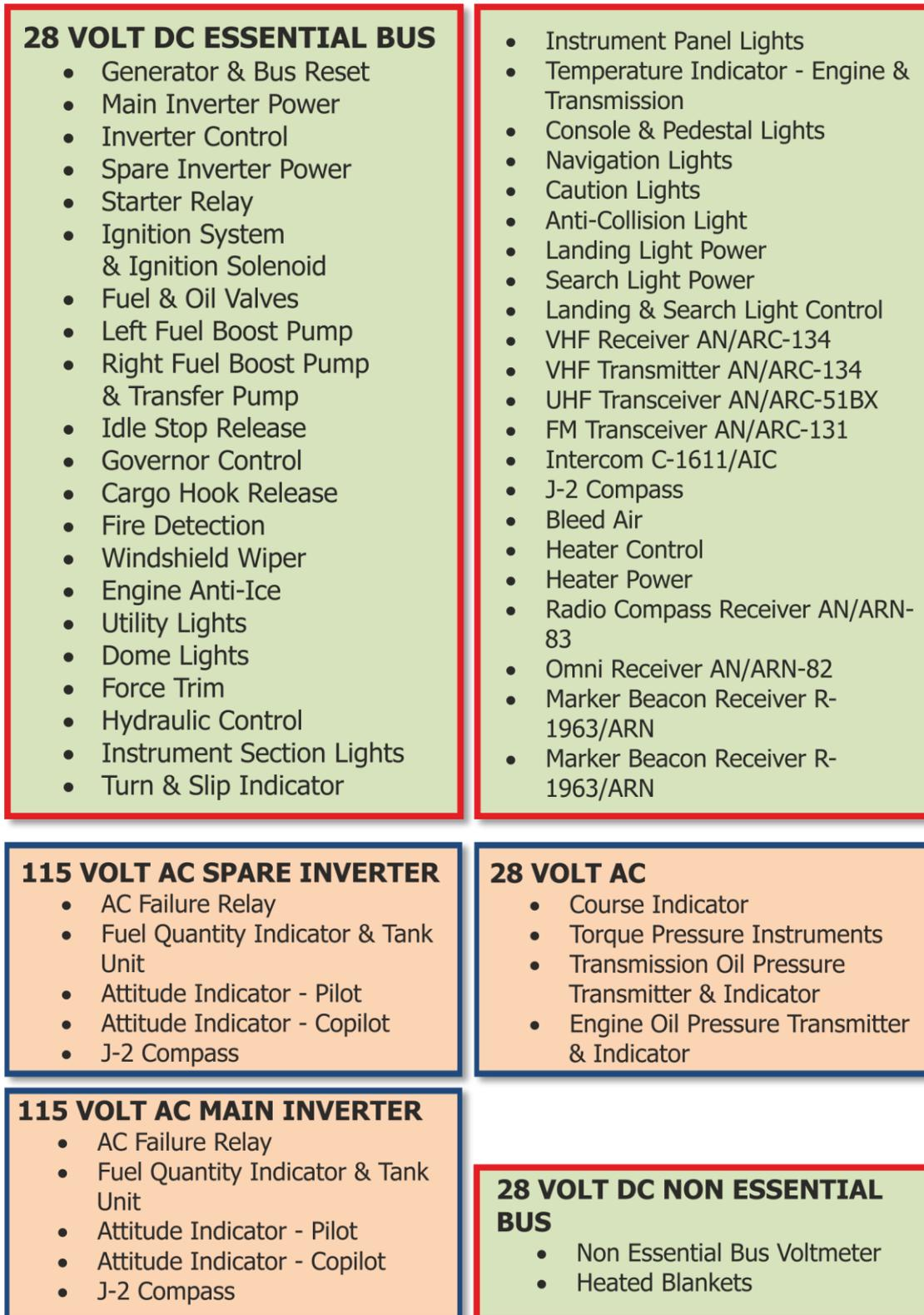
Abbildung 6-4: DC und AC Energieversorgung
