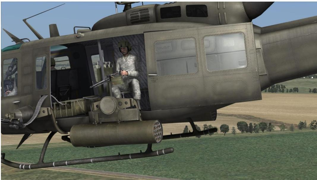
Abbildung 8-1: Das schwenkbar angebrachte M-60D MG auf der linken Hubschrauberseite
