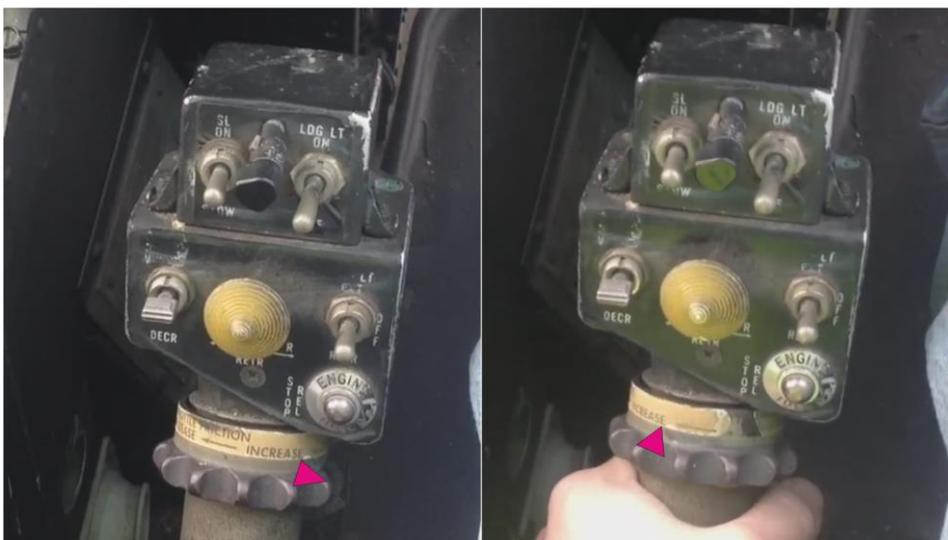
Abbildung 9-2: Position bei KOMPLETT ZUGEDREHT und an der LEERLAUFSPERRE<sup>91</sup>
