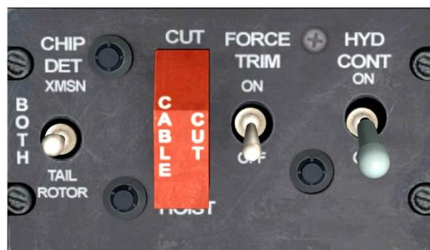
**Hydraulikschalter.** In der ON-Stellung werden die hydraulischen Servomotoren mit Hydraulikdruck versorgt. In der OFF-Stellung ist das zugehörige
