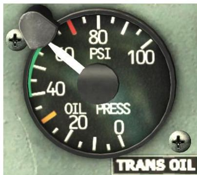
Die TRANS OIL Anzeige befindet sich im zentralen Bereich der Instrumententafel. Es zeigt den Öldruck im Getriebe in PSI an.
