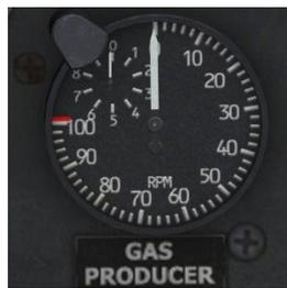
Der N1 Drehzahlanzeiger befindet sich im oberen mittleren Bereich des Instrumentenbretts und ist mit GAS PRODUCER beschriftet. Die Anzeige zeigt die Turbinendrehzahl in Prozent an. Die Werte werden einem am Triebwerkskompressor angebrachten Drehzahlmesser übermittelt. Eine Verbindung zur Stromversorgung ist hierbei nicht nötig.
