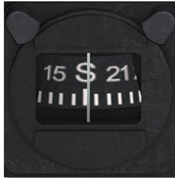
Der magnetische Kompass ist rechts an der Seite des zentralen Instrumentenbrettes montiert. Eine Anzeigeabweichung wird durch das Einschalten des Landelichtes, des Suchlichtes oder der Pitotrohr-Heizung verursacht.
