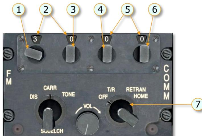
Abbildung 7-1-4: VHF FM Funkgerät AN/ARC-131
