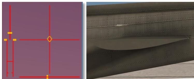
Abbildung 4-3: Position des synchronisierten Höhenleitwerks bei Neutralstellung des Steuerknüppels (-4.70 Grad).
