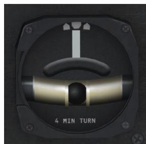
Der Wendeanzeiger (turn and slip indicator) zeigt Drehrichtung, Drehgeschwindigkeit und Seitengleitflug (slip) des Helikopters an.
