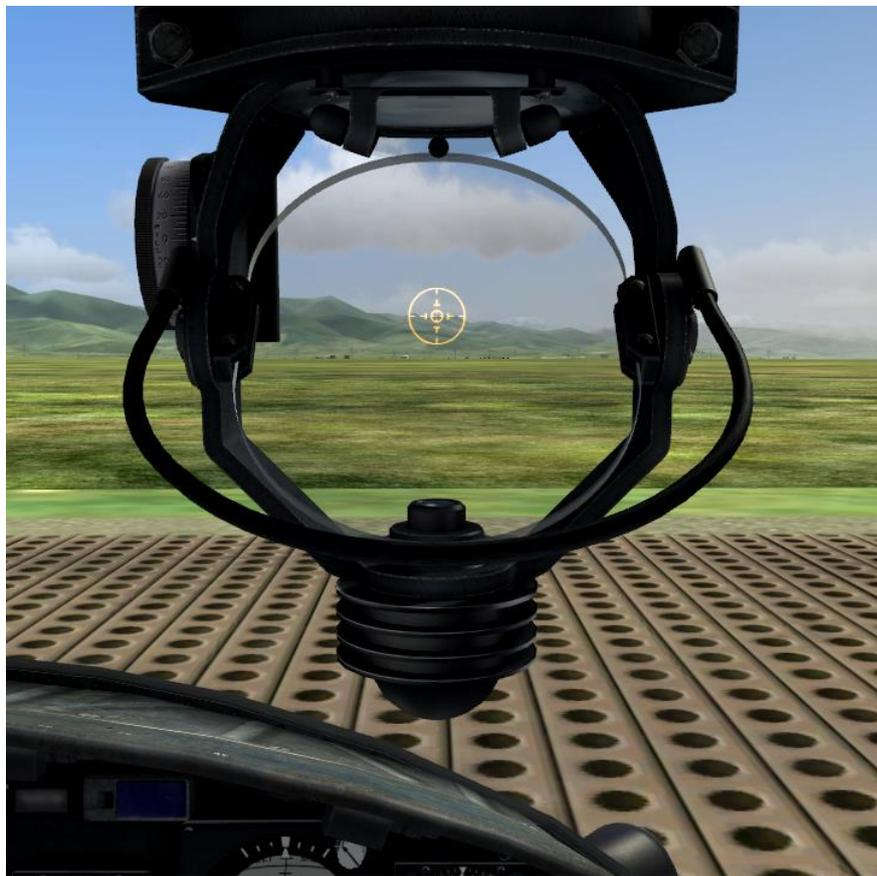
Abbildung 10-4: Das eingeschaltete XM60 Reflexvisier.
