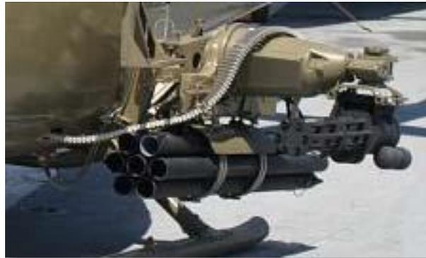
Abbildung 8-2: Teile des M21 Waffensystems an der linken Hubschrauberseite.
