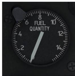
Die Kraftstoffvorratsanzeige befindet sich im oberen mittleren Bereich des Instrumentenbretts. Die Anzeige ist mit drei in den Tankzellen angebrachten Kraftstoffgebern verbunden. Zwei befinden sich in der rechten vorderen Zelle und einer in der mittleren rückwärtigen Zelle. Die angezeigten Werte müssen mit 100 multipliziert werden, um die Kraftstoffmenge in Pfund zu erhalten.
