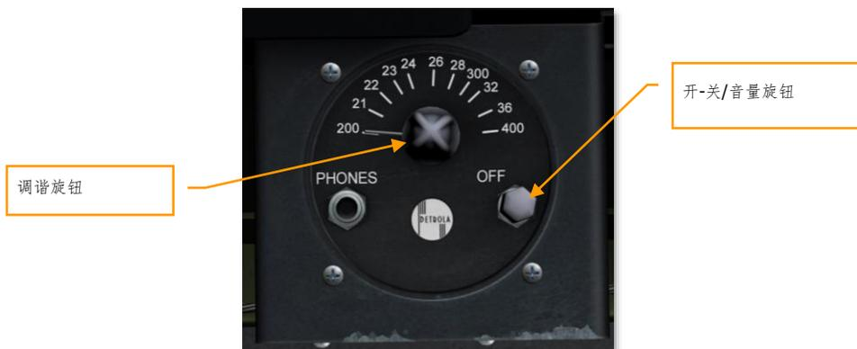
图 79: BC-1206“Detrola”无线电测距接收机
