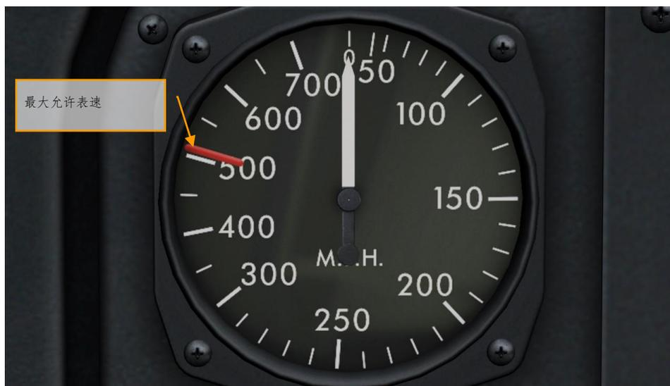
图 86: 最大允许指示空速 505 mph (808 km/h, 440 节)
