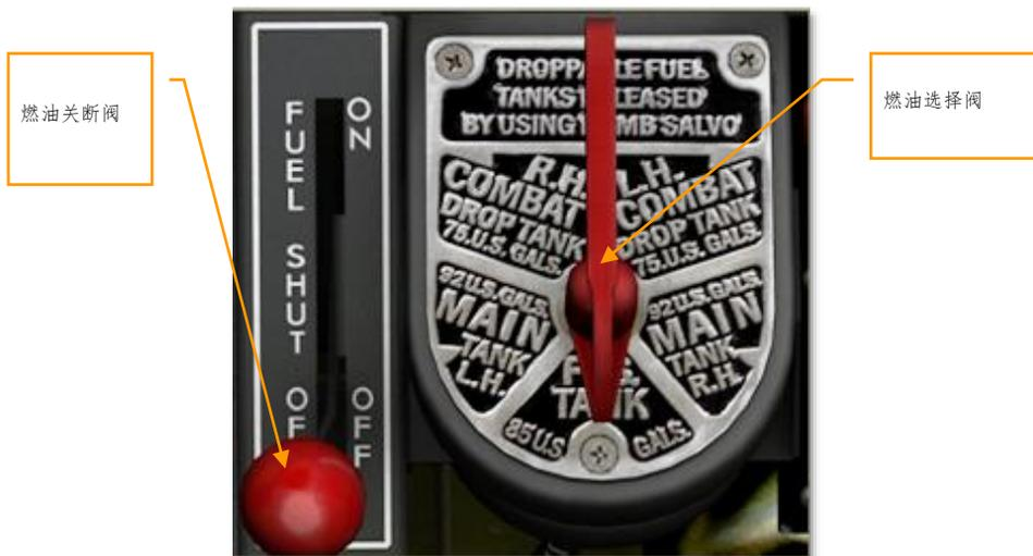
图 61：燃油关断和选择阀
