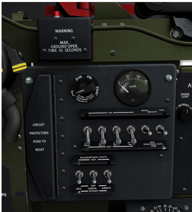
图 26：电气控制面板
