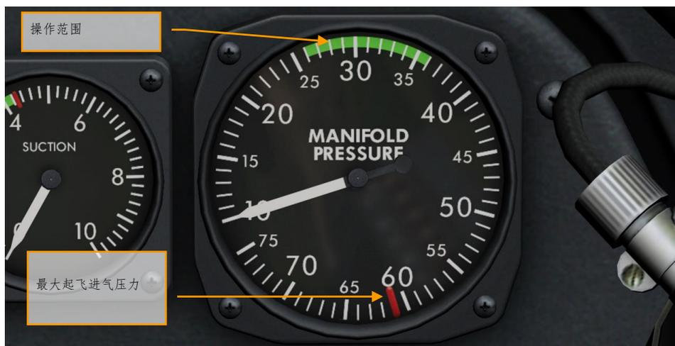
图 83：最大起飞进气压力 - 61 in. HG (155 cm HG) (红色标记)。操作范围 26 - 36 in. HG (66.04 - 91.44 cm HG) (绿色区域)。
