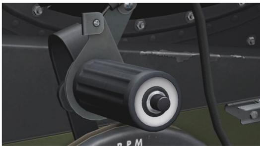
图 95: 带有旋转把手的油门控制手柄
