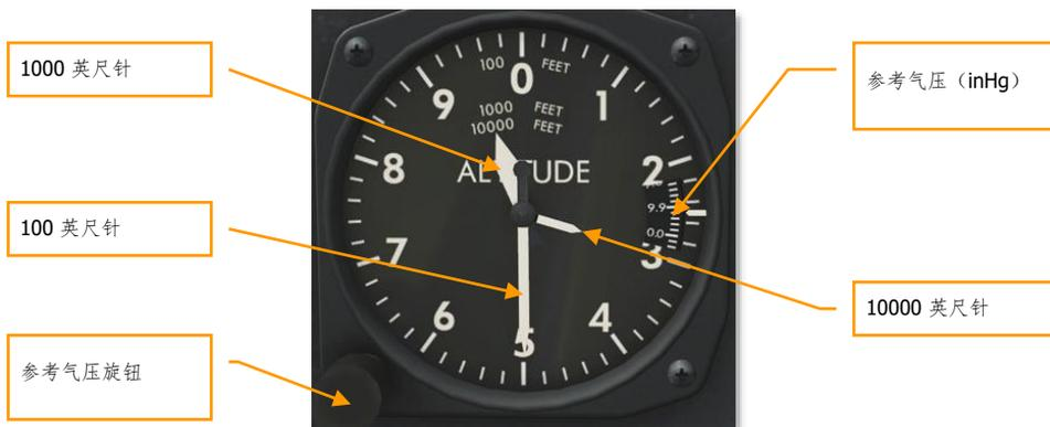
图 45：AN5760-2 气压高度表读数 29500 英尺
