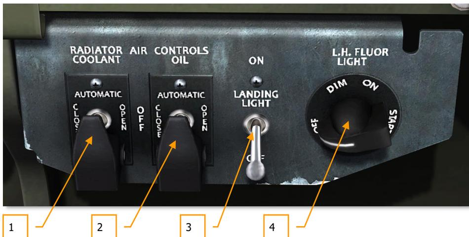
图 65：散热器空气控制面板
