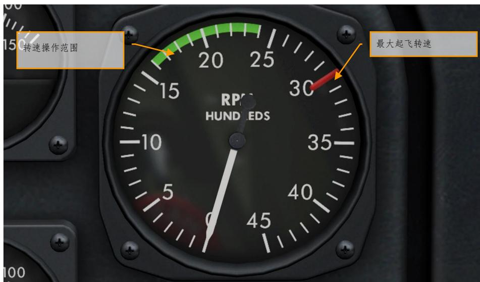
图 85: Max. 起飞转速 3000。操作范围 1600-2400。
