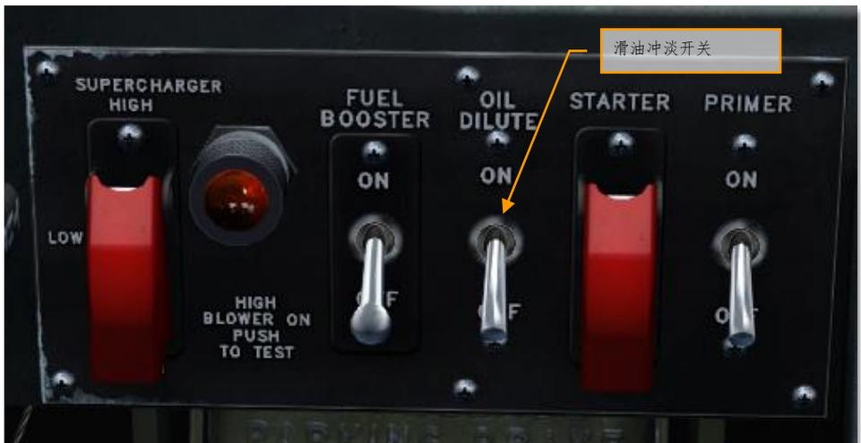
图 24: 滑油冲淡开关
