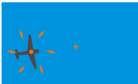
不正确——菱形内尖构成的虚拟环应符合目标的翼展。
