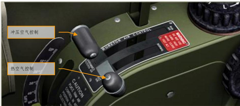
图 67：化油器空气控制
