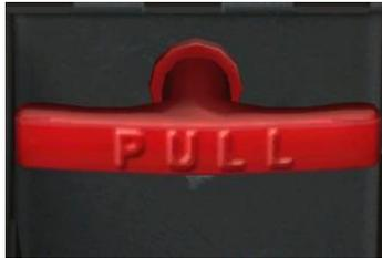
图 63: 起落架整流门应急释放手柄
