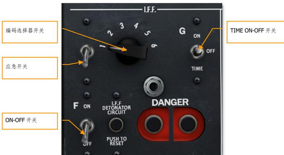
图 77: SCR-695-A IFF 无线电
