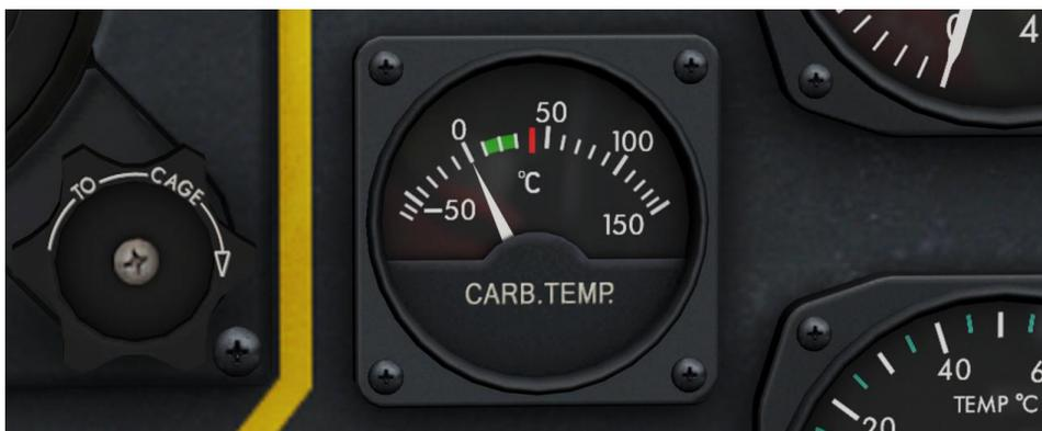
图 88: 理想的化油器空气温度范围 15-30°C (59-86°F), 最高 40°C (104°F)
