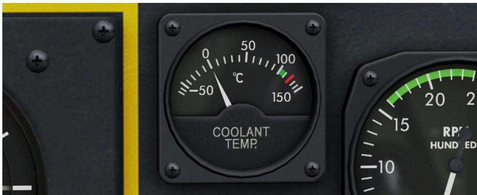
图 87: 最大冷却剂温度 121°C (250°F), 操作范围 100-110°C (212-230°F)
